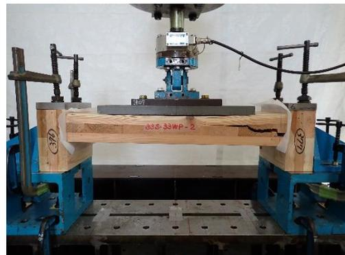
写真 4.5.4-4 No.3 33S-33WB-2 試験後
