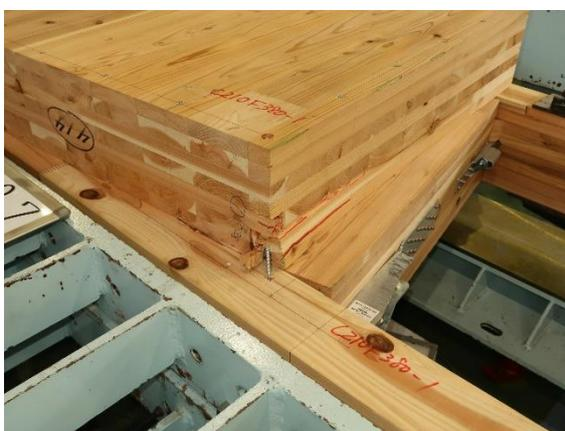
写真 6.5.3-3 C210F380-1 CLT 端部の割れ
