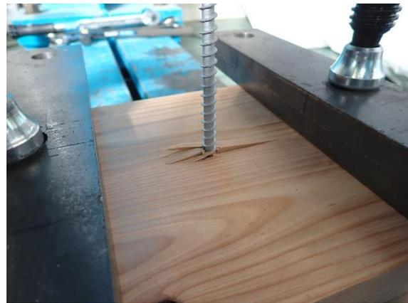
写真 7.5.1-4 NO.1 PL90-065'-3 試験後 表層のめくれ
