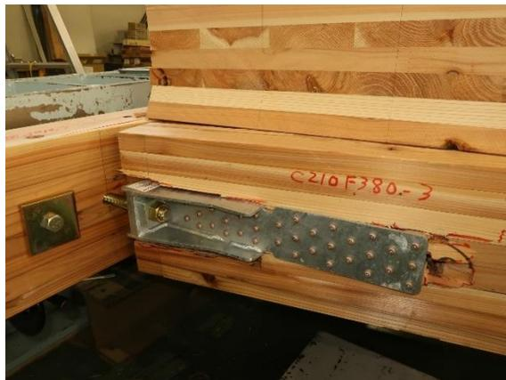
写真 6.5.3-8 C210F380-3 ホールドダウン金物部の集合型破壊
