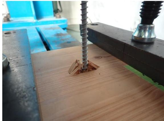
写真 7.5.1-2 NO.1 PL90-065'-1 試験後 表層のめくれ
