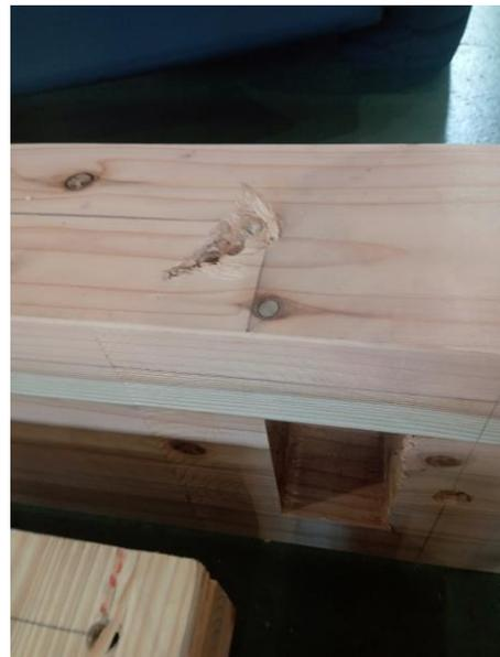
写真 6.5.1-10 C90F180 横架材のビス部のめり込み（面材端部）
