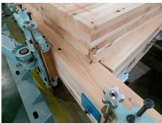
写真 6.5.2-3 C150F300 CLT 端部の割れ
