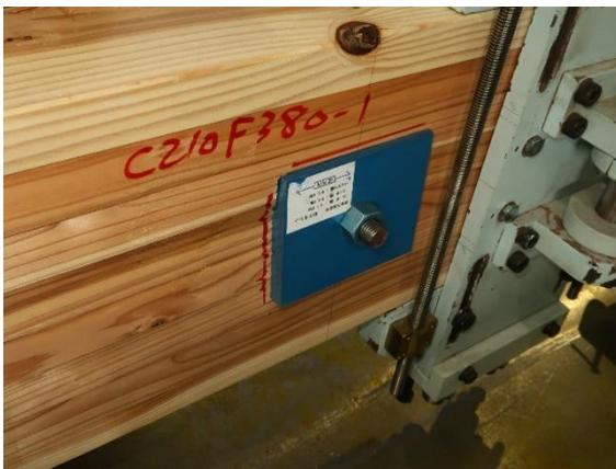
写真 6.5.3-7 C210F380-1 ホールドダウン金物の座金部分の木材へのめり込み
