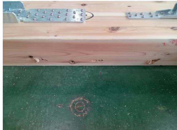
写真 6.5.1-8 C90F180 ビスによる軸組材へのめり込み
