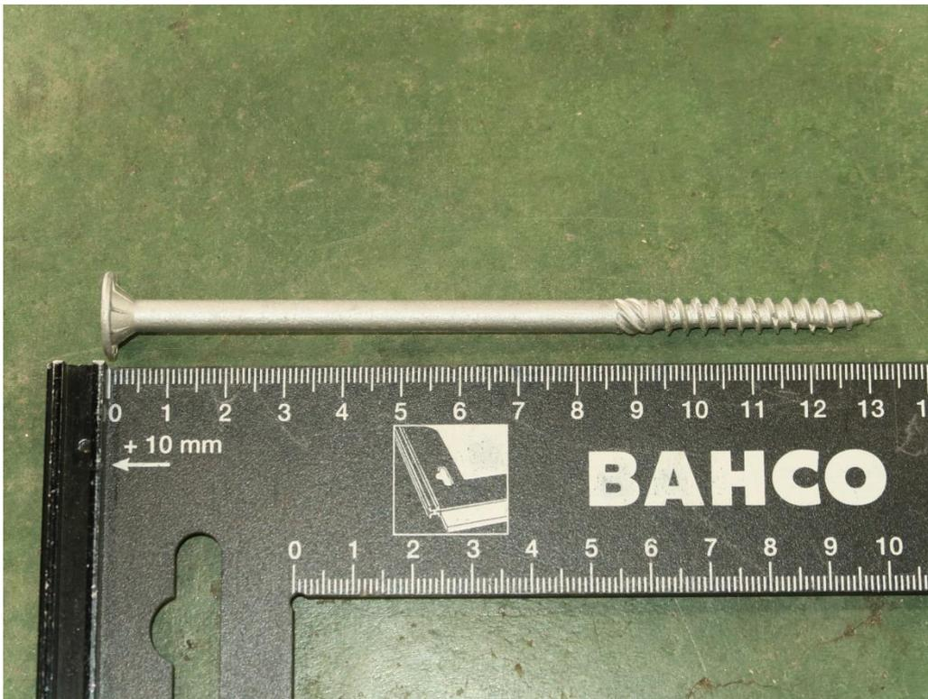
図 5.5-1 基整促 35 で使用した半ねじビス STS6.5F-L135 (コントロール)
