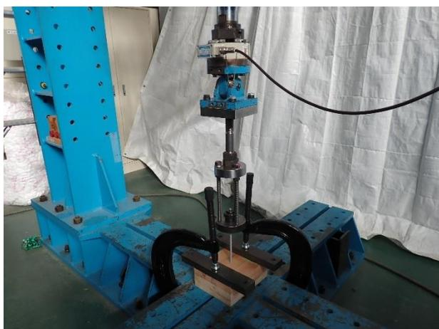
写真 7.4-1 引き抜き試験 直角
