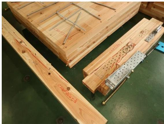
写真 6.5.3-10 C210F380-3 解体後 集合型破壊
