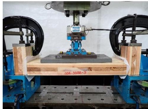
写真 4.5.1-6 No.1 33S-33SP-3 試験後
