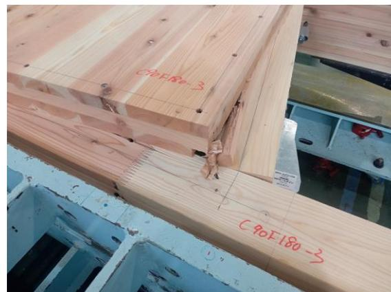
写真 6.5.1-4 C90F180 CLT 端部の割れ
