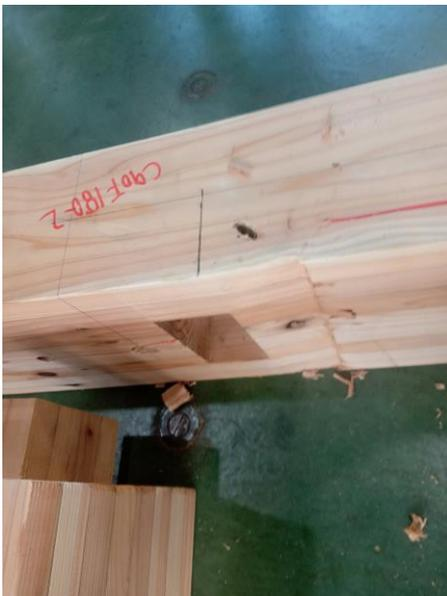
写真 6.5.1-9 C90F180 横架材のめり込み
