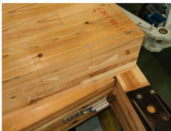
写真 6.5.3-4 C210F380-1 CLT パネルの回転
