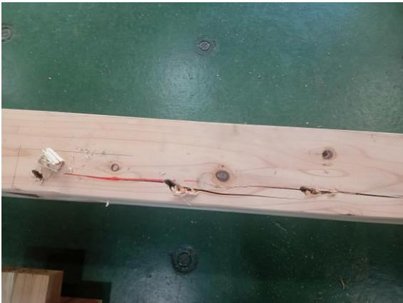
写真 6.5.1-7 C90F180 軸組み材の割れ
