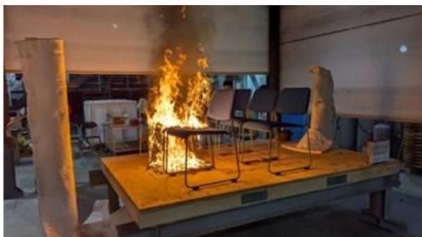
写真 1.4 椅子（2列×3脚）の燃焼試験
