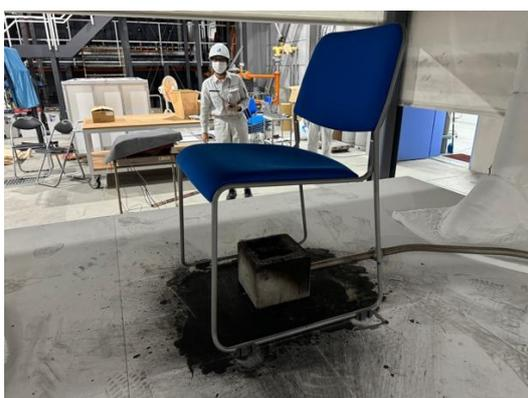
写真 2.3-1 椅子単体の燃焼実験
