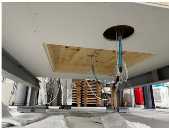
写真 2.4-2 熱流計と床試験体裏面の様子
