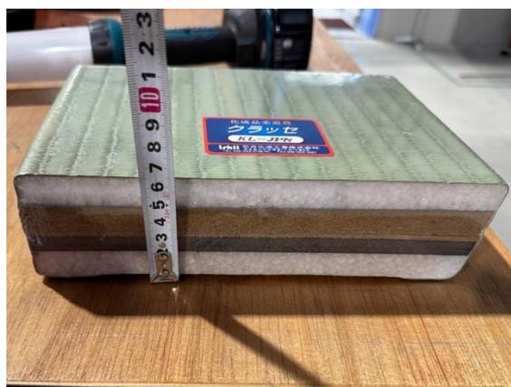
写真 2.5-2 柔道用畳の断面
