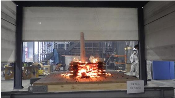
写真 2.4-9-17 床実験-4 着火 16 分後
