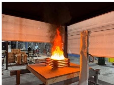
写真 2.2-2 実験 B・床の燃え抜け実験
