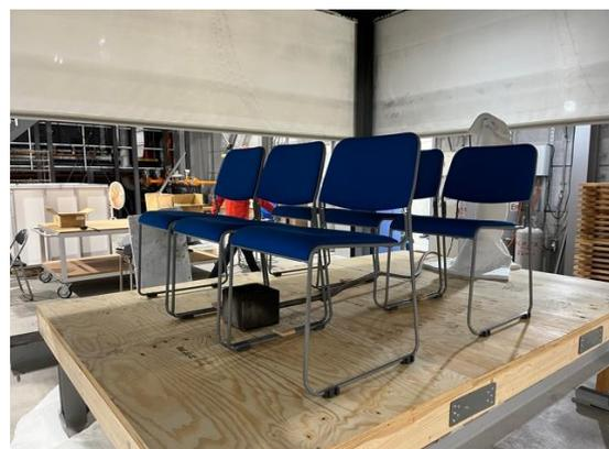
写真 2.3-2 椅子6脚の燃焼実験
