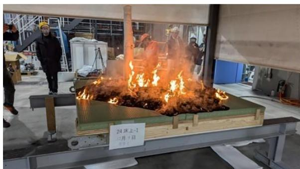
写真 1.5 柔道畳の燃焼試験
