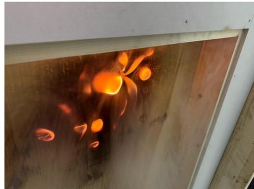
写真 2.4-6-28 床裏面 燃え抜け状況
