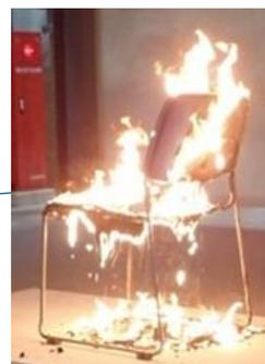
写真 4.2 椅子の燃焼試験の状況
