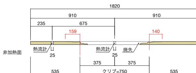
図 4.3 燃焼試験終了後の床の断面図
