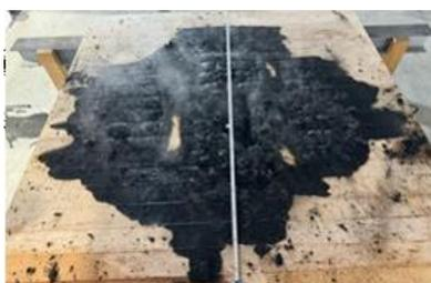
写真 4.3 燃焼試験終了後の床上の状況
