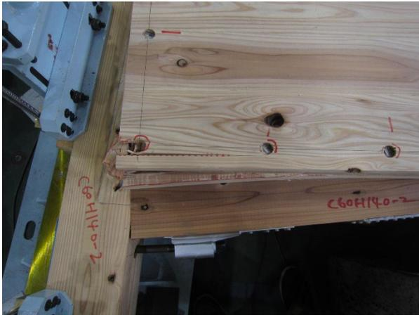
写真 4.4.4-9 2体目 CLTの割れ、ビスの引き抜け
