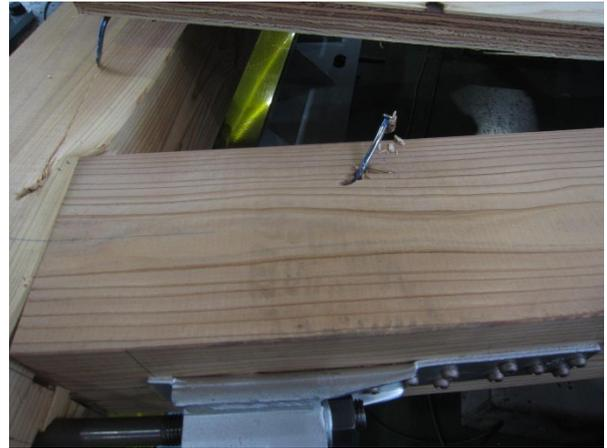
写真 4.4.1-2 1体目 梁材へのめり込み、くぎの引き抜け
