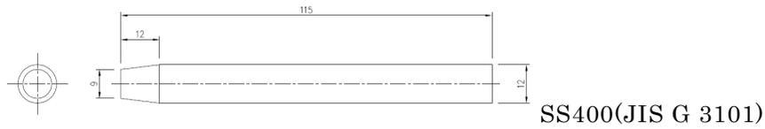
図 5.2.4-3 ドリフトピン  $\Phi 12$  L=115
