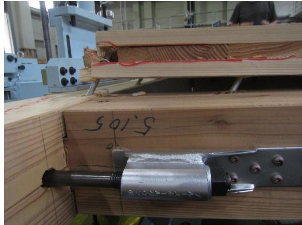
写真 4.4.4-10 2体目 CLTの割れ、ビスの引き抜け、CLTの浮き上がり
