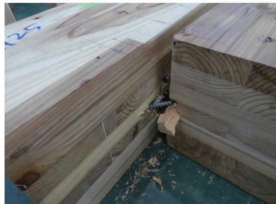
写真 3.5.3-8 NO.3 X90-5-7S-5 ビスの折損、木材の割れ
