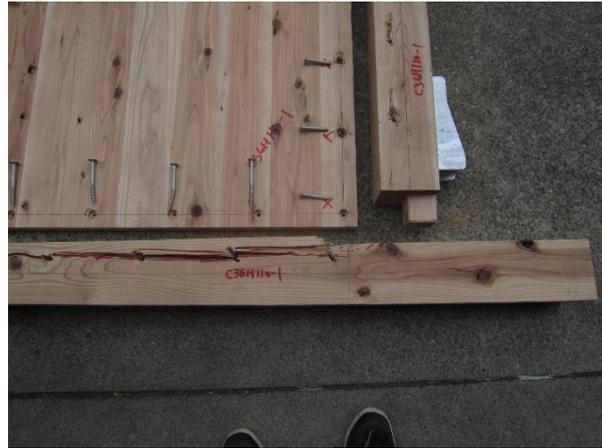
写真 4.4.3-8 1体目解体後 ビスの折損、木材の支圧、割れ
