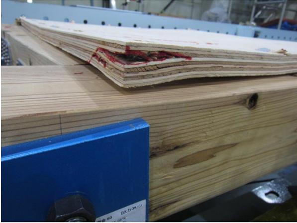
写真 4.4.2-7 2体目 合板端部の割れ、浮き上がり
