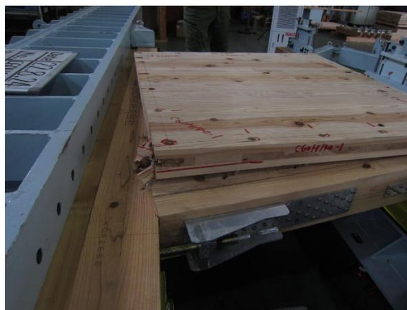
写真 4.4.4-4 1 体目 CLT 端部の割れ、ビス頭のめり込み
