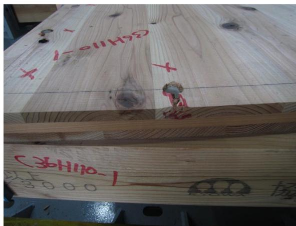
写真 4.4.3-4 1 体目 CLT 端部の割れ
