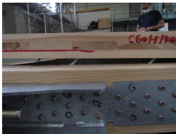
写真 4.4.4-6 1 体目 CLT の割れ、浮き上がり
