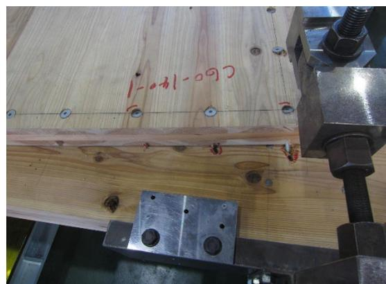
写真 5.4-7 梁 ビスの引き抜け、めり込み
