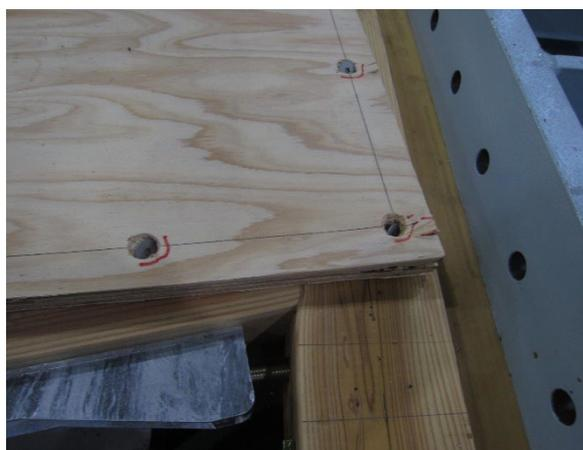
写真 4.4.2-4 1体目 柱脚部土台のめり込み
