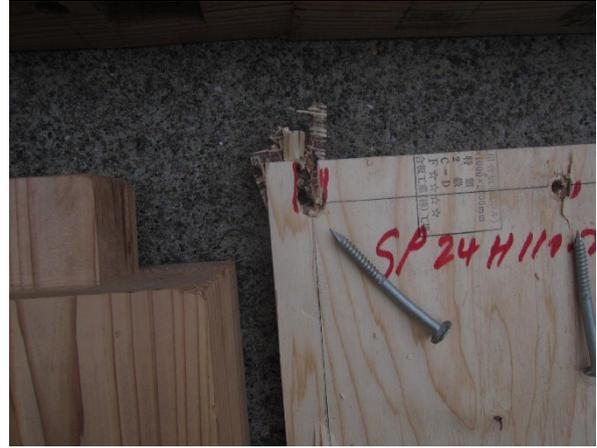
写真 4.4.2-8 2体目解体後 合板端部の割れ
