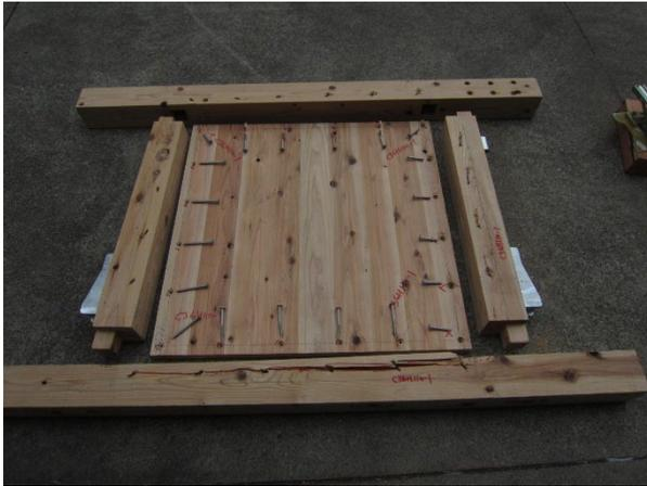
写真 4.4.3-7 1体目解体後 ビスの折損、横架材の割れ等
