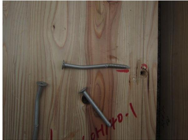
写真 4.4.4-8 1体目解体後 ビスの折損
