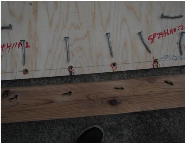
写真 4.4.2-9 2体目解体後 ビスの変形、合板の割れ
