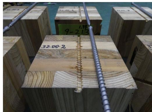
写真 7.4.3-4 2 体目 試験後
