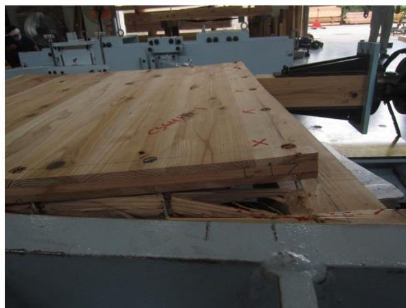
写真 4.4.3-2 1 体目 CLT の浮き上がり
