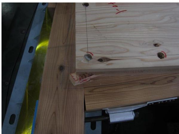
写真 4.4.4-3 1 体目 CLT 端部の割れ、ビス頭のめり込み
