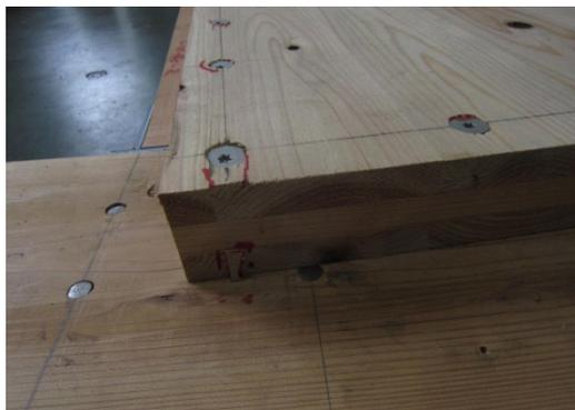
写真 5.4-8 幅はぎとビスが近い位置関係にあったが、脆性的な破壊は生じず。
