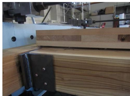
写真 5.4-9 CLT の浮き上がり
