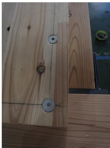
写真 5.4-1 試験前 ビスの打ち込み
