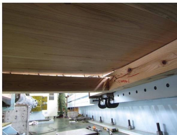
写真 4.4.3-6 1 体目 CLT の浮き上がり、
