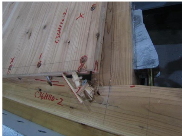
写真 4.4.3-10 2体目 CLT 端部の割れ、ビスの変形
