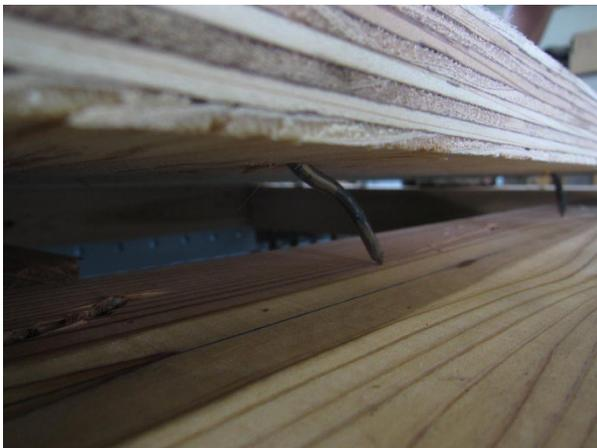
写真 4.4.1-5 1体目 くぎの変形・引き抜け
