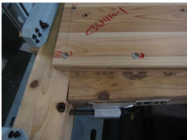
写真 4.4.3-3 1 体目 CLT 端部の割れ
