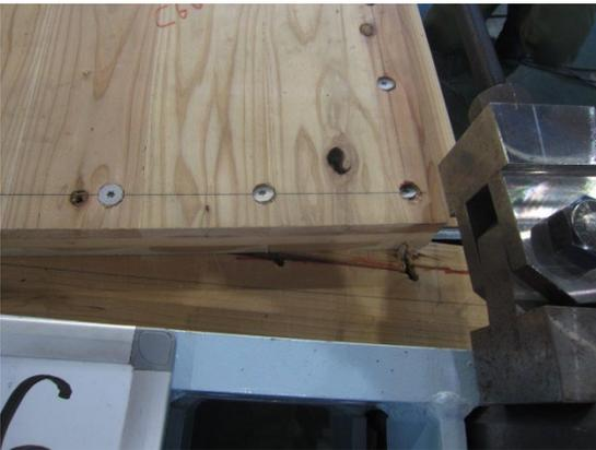
写真 5.4-4 試験後 加力側柱脚部
