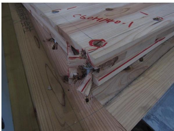
写真 4.4.4-5 1 体目 CLT 端部の割れ、ビス頭のめり込み
