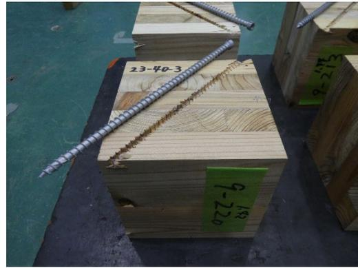
写真 7.4.2-6 3体目 試験後
