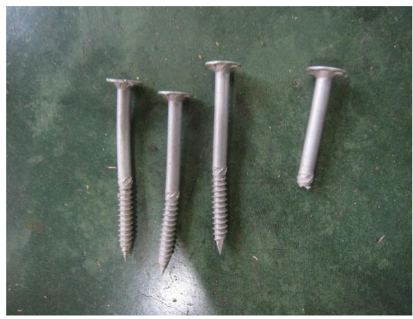
写真 4.4.2-10 2体目解体後 ビスの変形、折損
