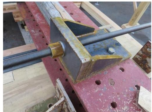
写真 4.3.11 タイロッド取付用製作金物
