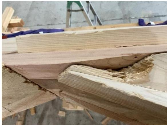
写真 2.2.4 CLT の欠損
