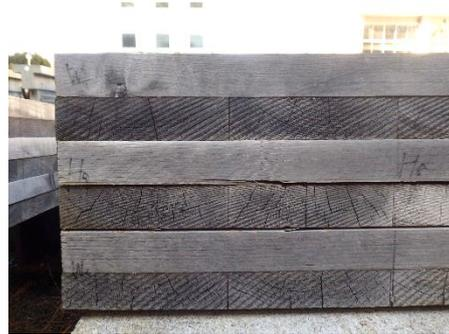
写真 7.1.6 幅方向の様子 (CLT-E-6ply-j-out)
