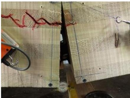
引き抜けせん断破壊
