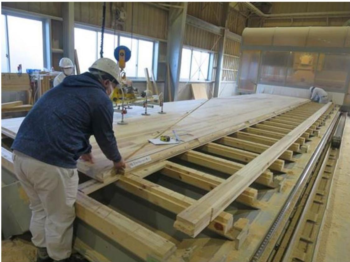
写真 4.7.1 CLT 加工風景
