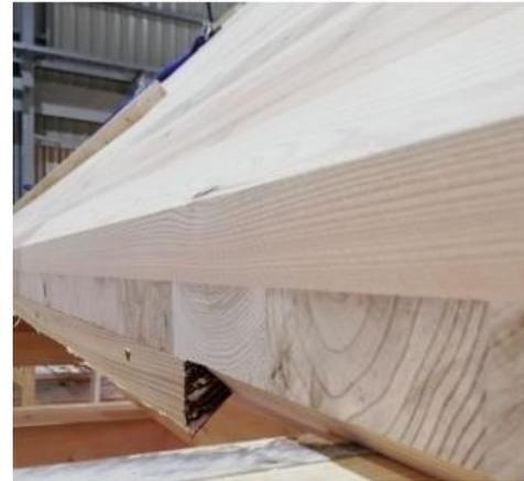
写真 2.2.5 ラミナの剥離落下
