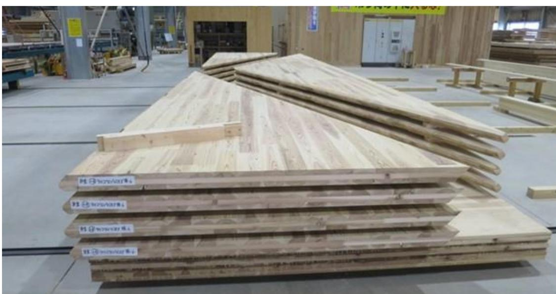
写真 4.7.2 成型加工された CLT
