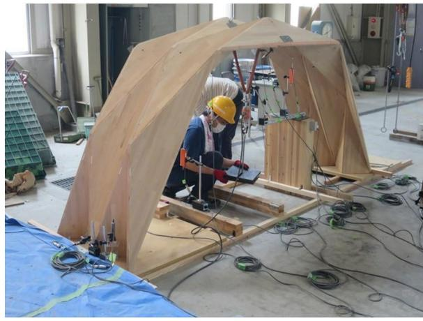
写真 3.4 中央荷重載荷の様子
