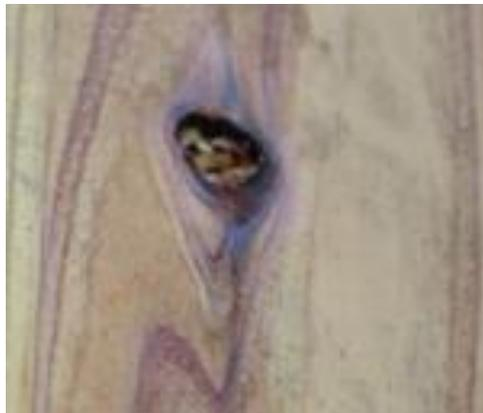
写真 5.3.1 CLT 表面上の死節
