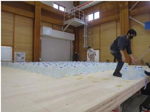
写真 1.2 床スラブの静的載荷試験
