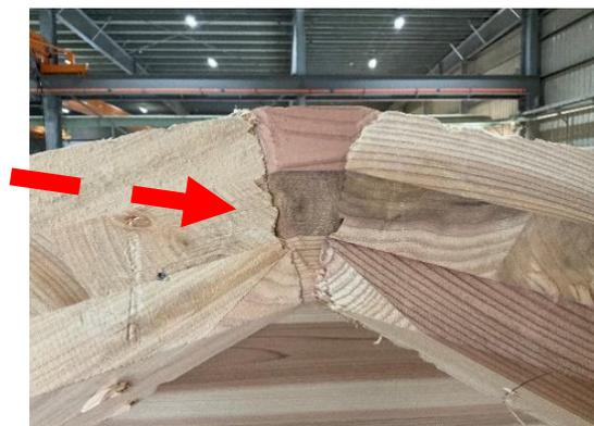
写真 2.2.6 6枚のCLTが取り合う頂部
