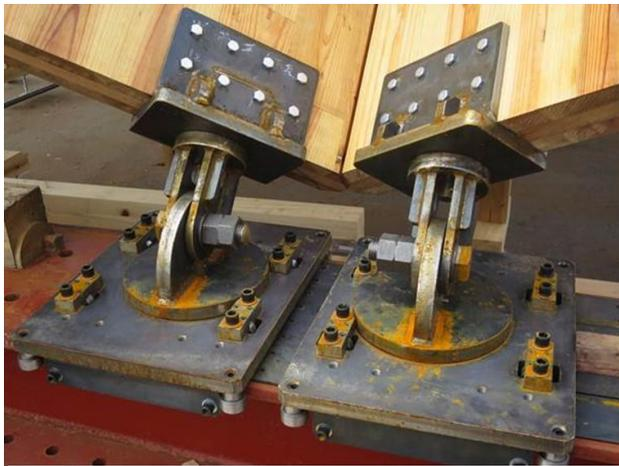
写真 4.4.3 支承金物と CLT の接合 (上面)
