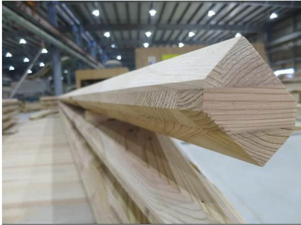
写真 4.7.4 成型加工後の CLT
