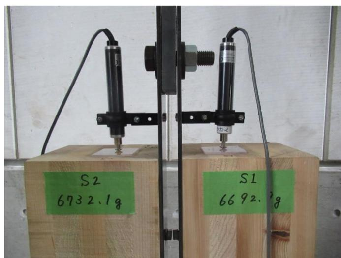
写真 7.3.2 変位計設置の様子
