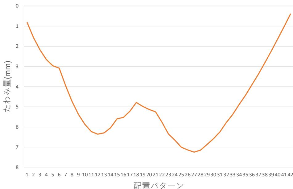
図 4.9 配置パターンによる中央たわみの変化（4枚：2辺支持（長手））
