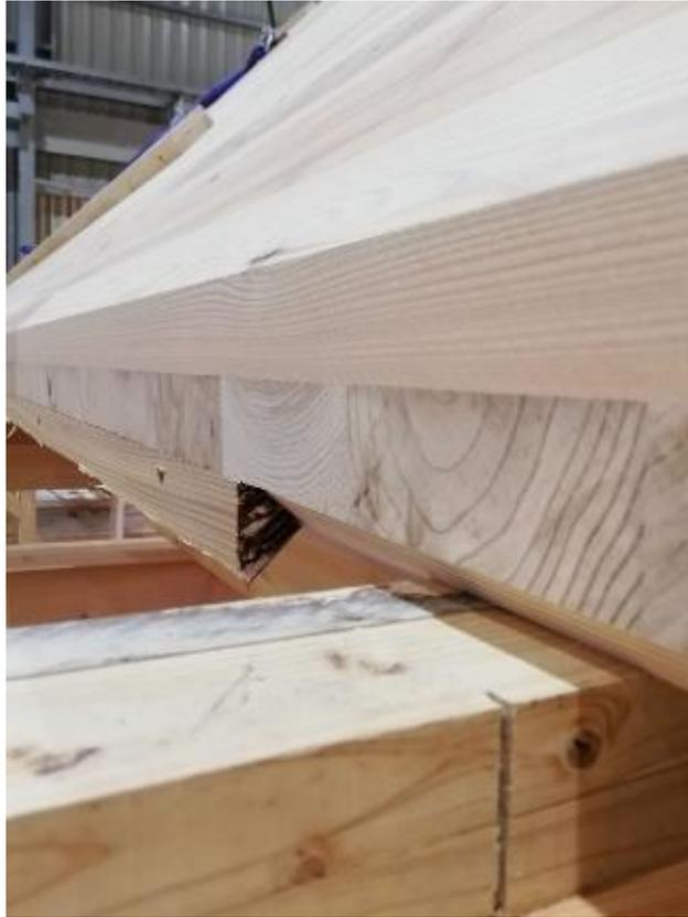
写真 8.7 ラミナ脱落状況
