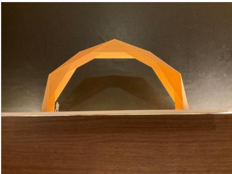
写真 8.2 CLT 折版構造架構模型 (立面)
