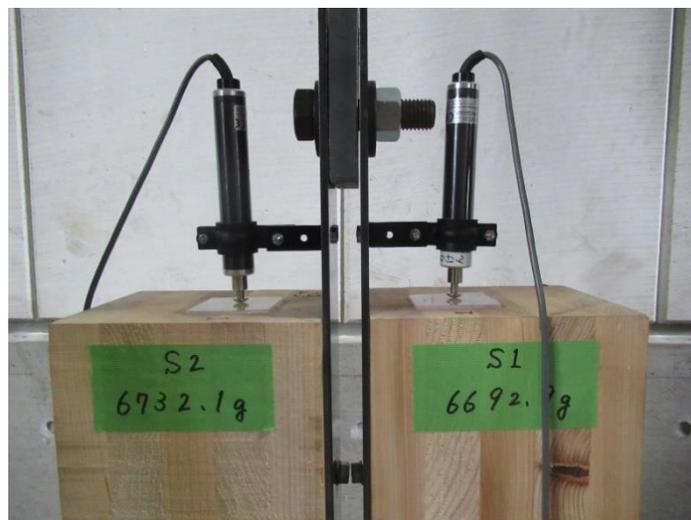
写真 7.14 変位計設置の様子
