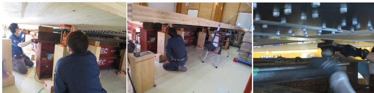
写真 2.8 試験体支持条件の盛替え風景
