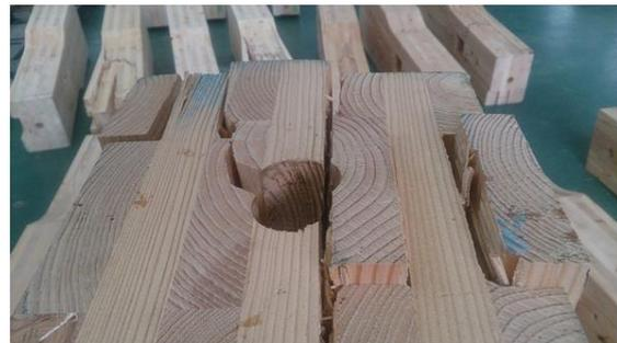
写真 5.4-28 KS9077-3 試験体両脇部分のローリングシア破壊
