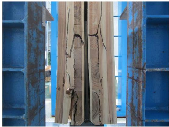
写真 8.4-5 S57D09-2 内層のローリングシア破壊
