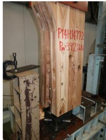
写真 6.4-18 P14H1477-2 試験体スリット部からの開き
