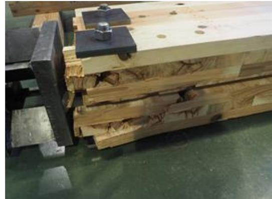
写真 6.4-66 P08H1477B-3 内層のローリングシア破壊、ピンによる外層ラミナの割裂破壊、ピンによる外層ラミナの押し抜きせん断破壊、内層ラミナの引張破壊
