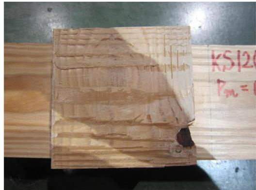
写真 4.4-44 KS120BW-6 試験後の接着面
