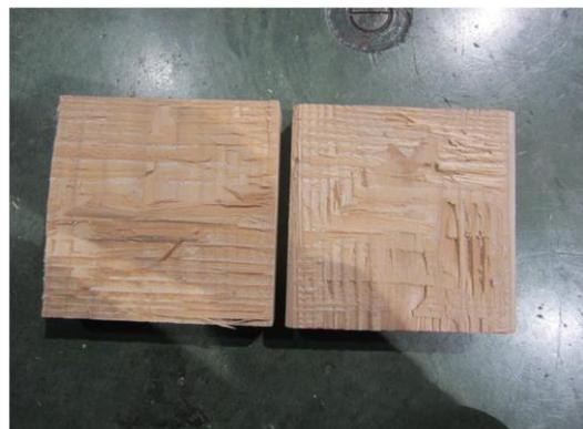
写真 4.4-20 KS90BS-6 試験後の接着面
