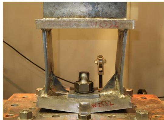
写真 7.4-13 W2532 底板 D の曲げ変形、側板 C の曲げ変形
