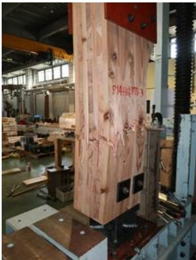
写真 6.4-51 P14H1477B-3 CLT の引張破壊
