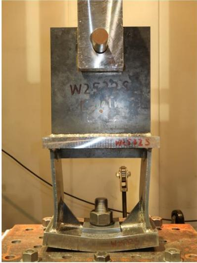
写真 7.4-15 W2532S 底板 D の曲げ変形、側板 C の曲げ変形
