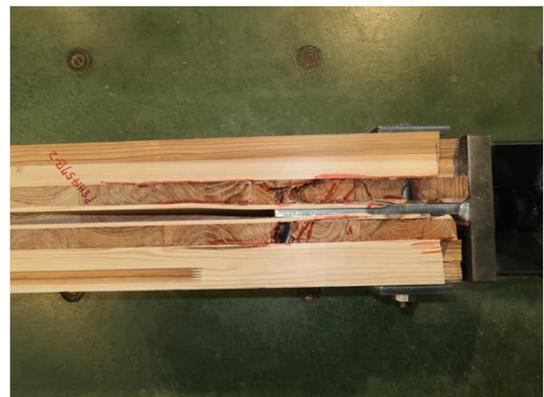
写真 6.4-43 P08H1457B-2 内層のローリングギア破壊、ピンによる外層ラミナの割裂破壊、ピンによる外層ラミナの押し抜きせん断破壊
