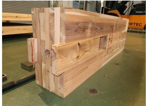
写真 5.4-30 SM6077W-2 座金下部外層ラミナのローリングシア破壊
