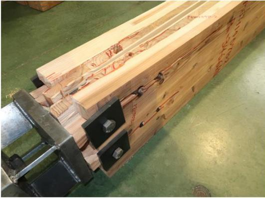
写真 6.4-44 P08H1457B-2 内層のローリングシア破壊、ピンによる外層ラミナの割裂破壊、ピンによる外層ラミナの押し抜きせん断破壊
