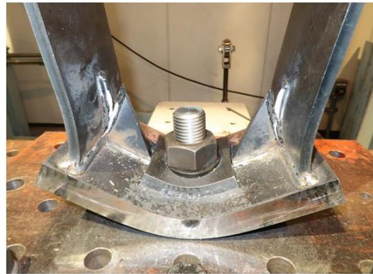
写真 7.4-11 W1925 底板 D の曲げ変形、側板 C の曲げ変形
