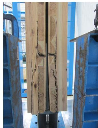
写真 8.4-3 S57D09-1 内層のローリングシア破壊
