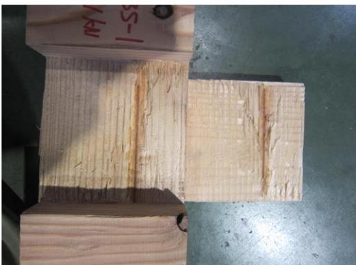
写真 4.4-19 KS90BS-1 試験後の接着面
