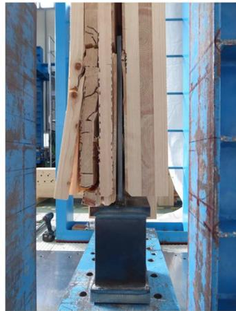
写真 8.4-74 H77D06-5 内層ラミナのローリングシア破壊
