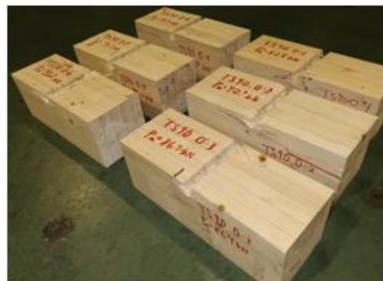
写真 3.5-13 トドマツ TS900 の破壊性状
