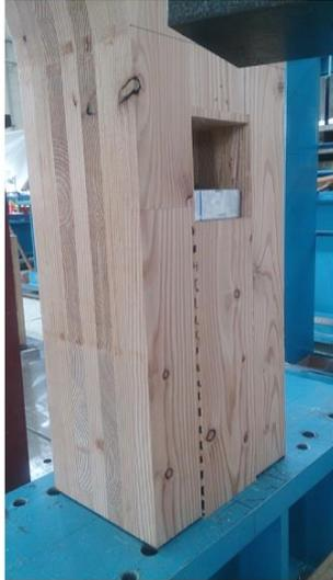
写真 5.4-5 HS9057-1 座金下部外層ラミナのローリングシア破壊
