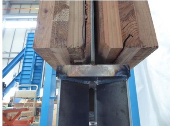
写真 8.4-22 S77D09H 内層ラミナの引張破壊
