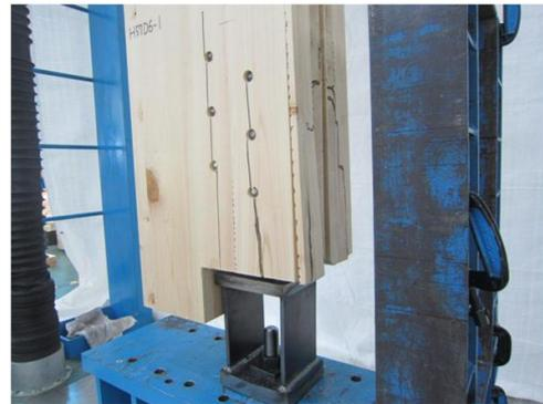
写真 8.4-50 H57D06-1 内層のローリングシア破壊、ピンによる外層ラミナの割裂破壊
