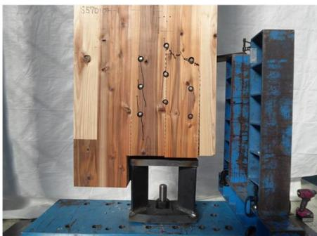
写真 8.4-11 S57D09H ピンによる外層ラミナの割裂破壊、外層ラミナの引張破壊
