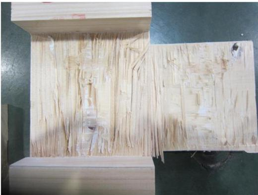
写真 4.4-15 HS90BS-1 試験後の接着面
