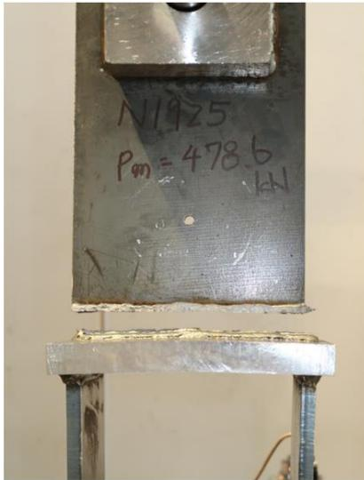
写真 7.4-1 N1925 鋼板 A と上板 B 間の溶接部の破断
