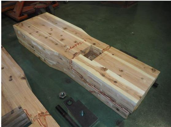
写真 5.4-13 SM6077-1 CLT の引張破壊
