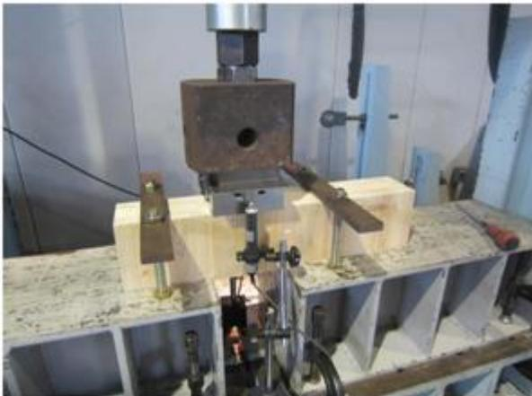
写真 4.3-1 外層加力試験体
