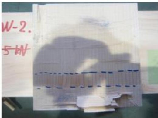
写真 4.5-3 接着塗布時の不良
