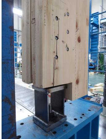
写真 8.4-60 H57D06-4 内層のローリングシア破壊、ピンによる外層ラミナの割裂破壊
