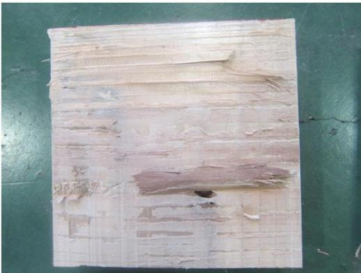
写真 4.4-33 SS60BW-1 試験後の接着面
