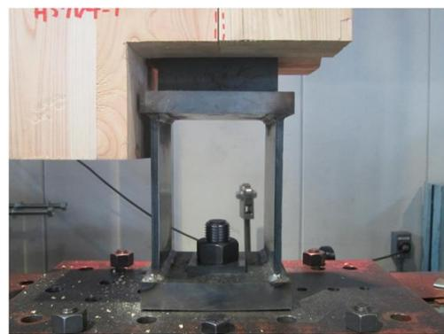
写真 8.4-79 H57D04-1 金物の曲げ変形
