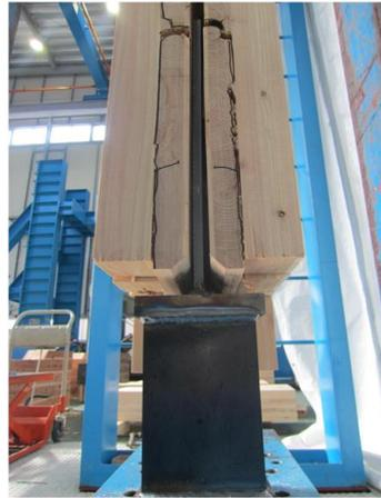
写真 8.4-63 H57D06H 内層のローリングシア破壊
