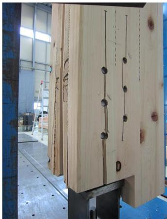
写真 8.4-59 H57D06-3 内層のローリングシア破壊、ピンによる外層ラミナの割裂破壊
