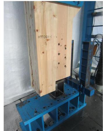
写真 8.4-75 H77D06-H 内層ラミナの引張破壊
