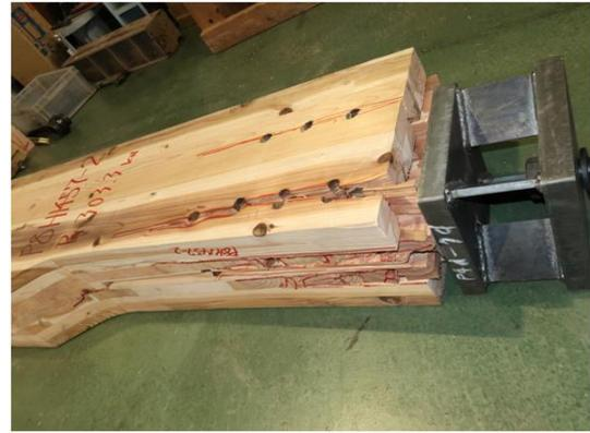
写真 6.4-13 P08H1457-2 内層のローリングシア破壊、ピンによる外層ラミナの割裂破壊
