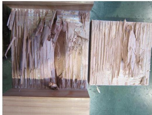
写真 4.4-10 SS30BS-6 試験後の接着面
