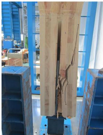
写真 8.4-76 H77D06-H 内層ラミナの引張破壊
