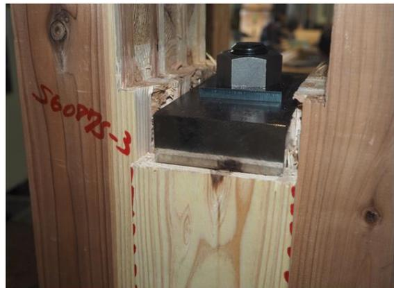
写真 5.4-16 SM6077-3 座金下部外層ラミナのローリングシア破壊
