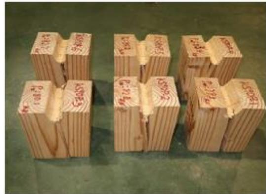
写真 3.5-9 カラマツ TS90P の破壊性状
