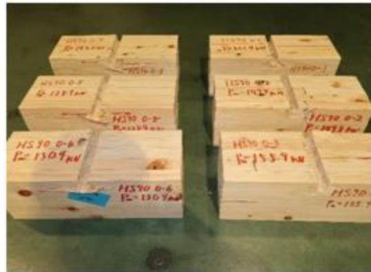
写真 3.5-17 ヒノキ HS900 の破壊性状
