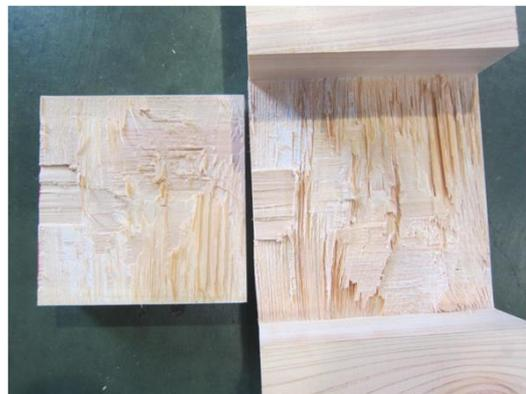
写真 4.4-18 HS120BS-6 試験後の接着面
