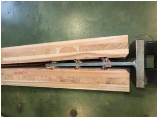
写真 6.4-19 P14H1477-2 試験体スリット部からの開き
