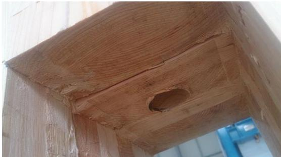
写真 5.4-7 HS9057-3 座金下部外層ラミナのローリングシア破壊
