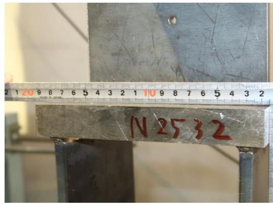
写真 7.4-6 N2532 上板 B の曲げ変形
