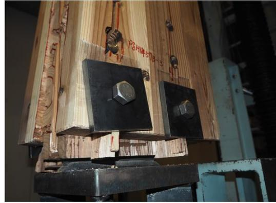
写真 6.4-47 P08H1457B-3 内層のローリングシア破壊、ピンによる外層ラミナの割裂破壊、ピンによる外層ラミナの押し抜きせん断破壊
