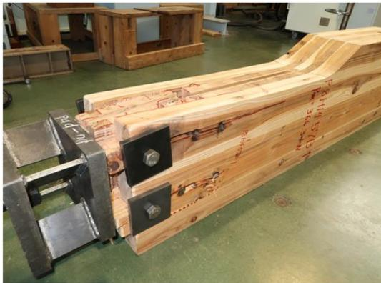
写真 6.4-40 P08H1457B-1 内層のローリングギア破壊、ピンによる外層ラミナの割裂破壊、ピンによる外層ラミナの押し抜きせん断破壊
