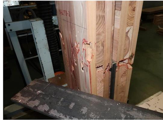
写真 6.4-55 P14H0677B-2 CLT の引張破壊
