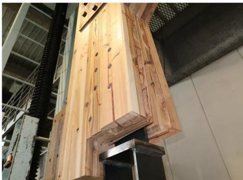
写真 8.4-28 S57D06-2 内層のローリングシア破壊、ピンによる外層ラミナの割裂破壊
