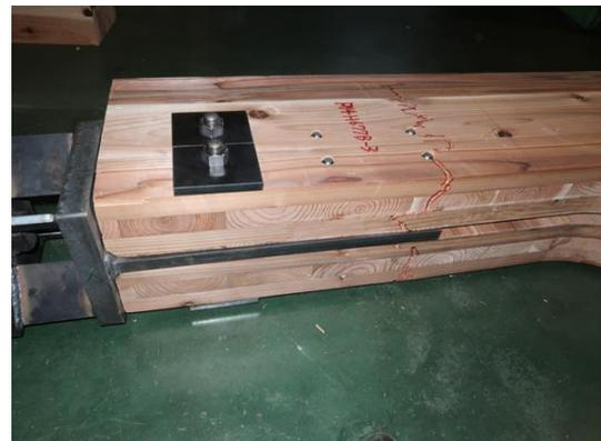
写真 6.4-57 P14H0677B-3 CLT の引張破壊
