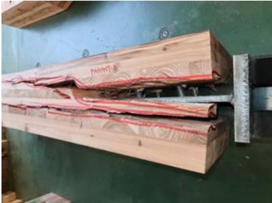
写真 6.4-4 P14H1457-3 試験体スリット部からの開き
