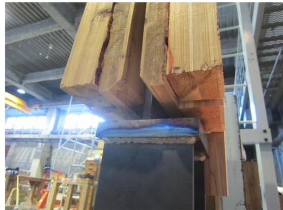
写真 8.4-37 S57D06H 内層のローリングシア破壊
