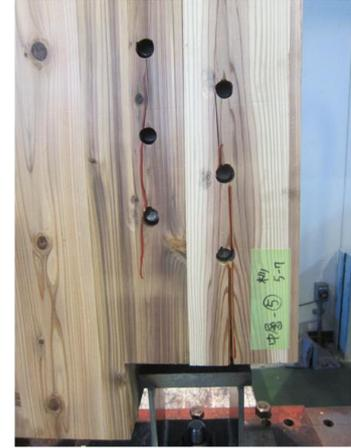
写真 8.4-32 S57D06-3 ピンによる外層ラミナの割裂破壊
