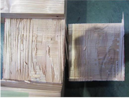
写真 4.4-13 SS90BS-1 試験後の接着面
