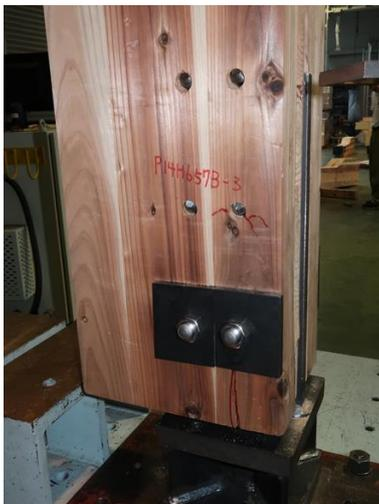
写真 6.4-37 P14H0657B-2 外層に若干の割れあり(ただし、試験体としては破壊に至っていない)
