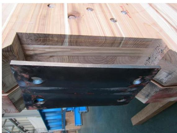
写真 10.4-7 SS77D05-1 金物の変形
