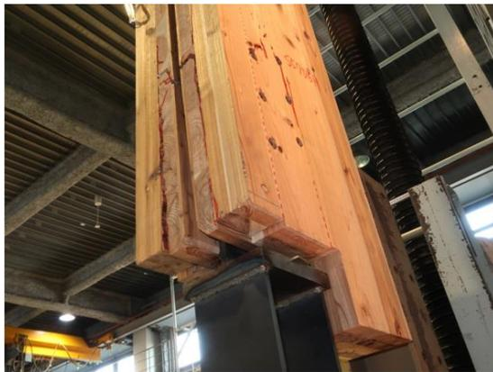
写真 8.4-36 S57D06H 内層のローリングシア破壊、ピンによる外層ラミナの割裂破壊、外層ラミナの引張破壊
