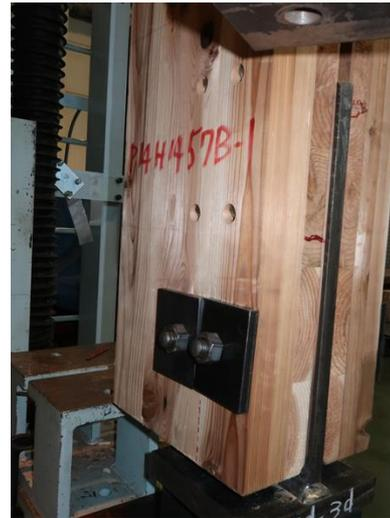
写真 6.4-34 P14H0657B-1 破壊なし
