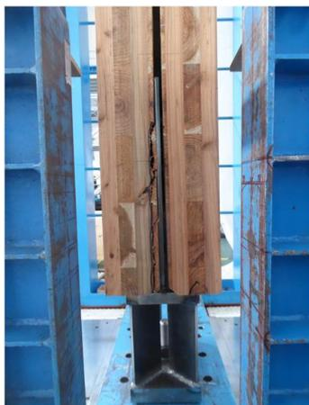
写真 8.4-21 S77D09H 内層のローリングシア破壊
