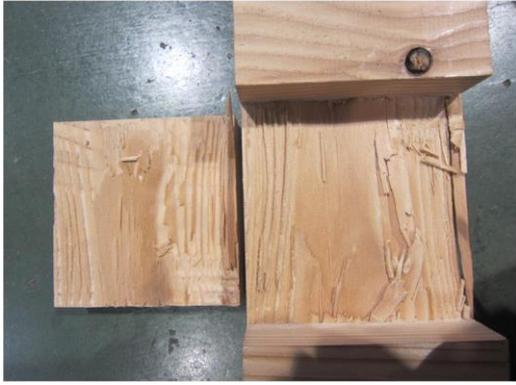
写真 4.4-21 KS120BS-1 試験後の接着面
