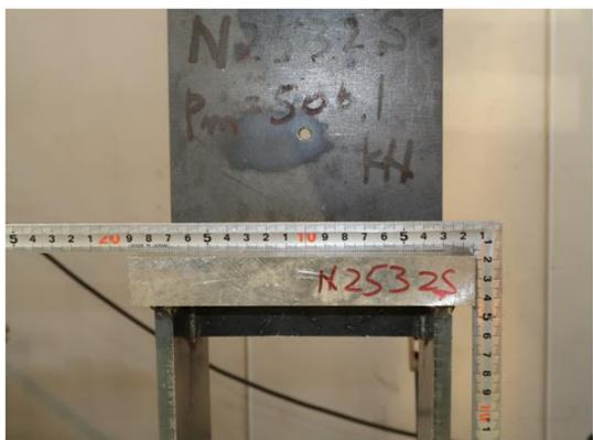
写真 7.4-9 N2532S 上板 B の曲げ変形
