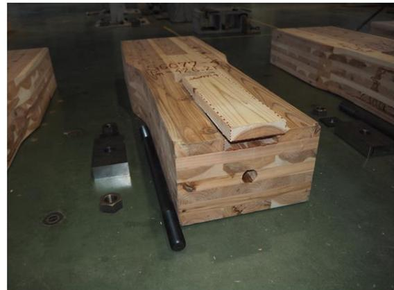
写真 5.4-20 SM6077R-4 座金下部外層ラミナのローリングシア破壊
