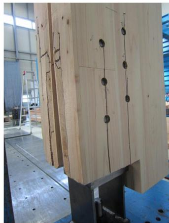
写真 8.4-57 H57D06-2 内層のローリングシア破壊、ピンによる外層ラミナの割裂破壊
