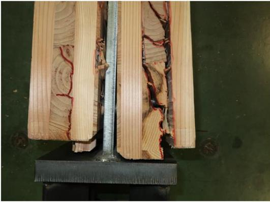
写真 6.4-27 P08H1477-1 内層ラミナの引張破壊
