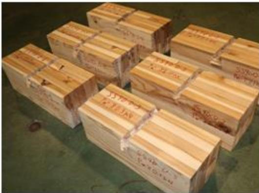
写真 3.5-16 スギ SS900 の破壊性状
