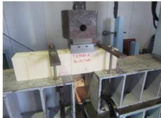
写真 4.4-2 外層加力試験の実験の様子
