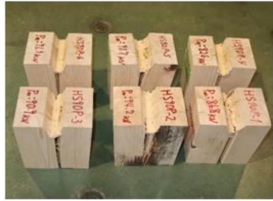
写真 3.5-7 ヒノキ HS90P の破壊性状
