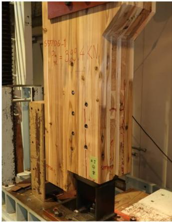
写真 8.4-23 S57D06-1 内層のローリングシア破壊、ピンによる外層ラミナの割裂破壊
