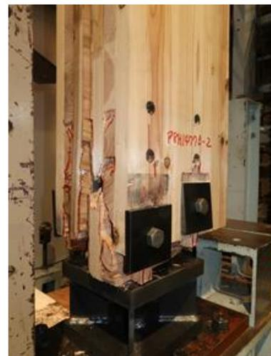
写真 6.4-62 P08H1477B-2 内層のローリングシア破壊、ピンによる外層ラミナの割裂破壊、ピンによる外層ラミナの押し抜きせん断破壊、内層ラミナの引張破壊
