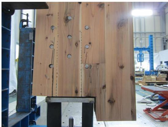
写真 8.4-13 S77D09-1 ピンによる外層ラミナの割裂破壊
