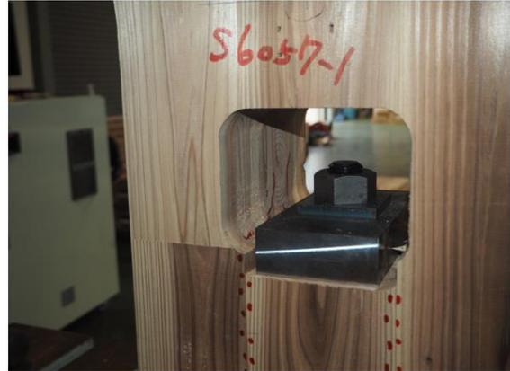
写真 5.4-2 SM6057R-1 試験体両脇部分のローリングシア破壊
