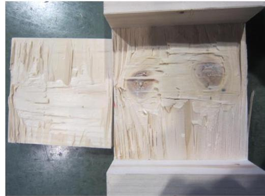
写真 4.4-8 TS90BS-6 試験後の接着面
