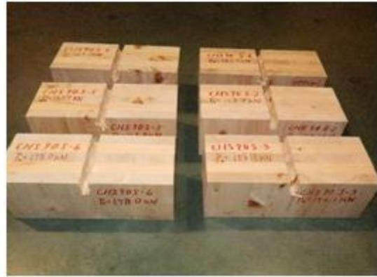
写真 3.5-23 ヒノキ CHS90S の破壊性状
