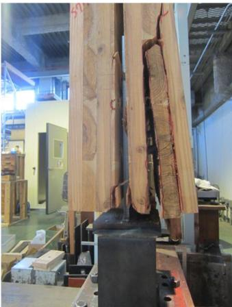
写真 8.4-47 S77D06H スリット部からの面外への開き、内層のローリングシア破壊
