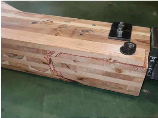
写真 6.4-54 P14H0677B-1 CLT の引張破壊
