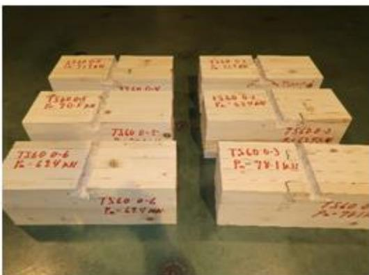
写真 3.5-12 トドマツ TS600 の破壊性状
