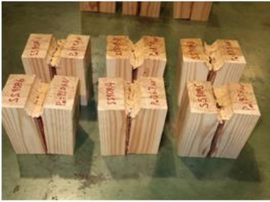
写真 3.5-6 スギ SS90P の破壊性状
