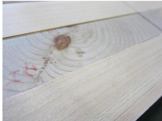
写真 4.4-26 内層加力試験 試験後の加圧面
