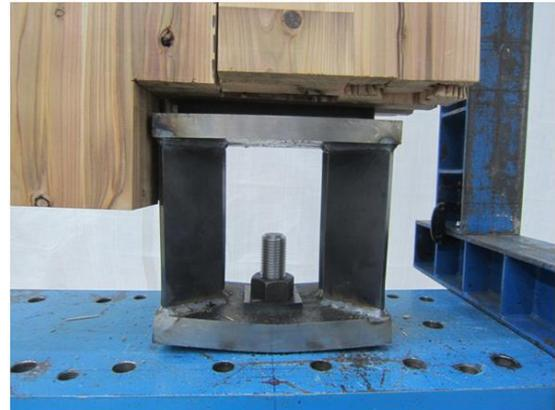
写真 8.4-1 S57D09-1 金物底板の曲げ変形
