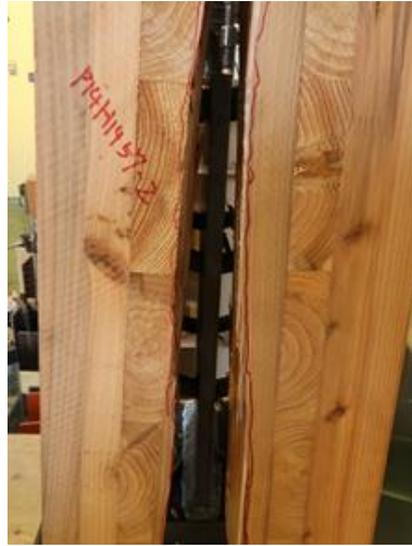
写真 6.4-3 P14H1457-2 試験体スリット部からの開き
