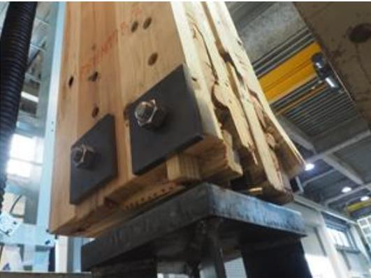
写真 6.4-65 P08H1477B-3 内層のローリングシア破壊、ピンによる外層ラミナの割裂破壊、ピンによる外層ラミナの押し抜きせん断破壊、内層ラミナの引張破壊
