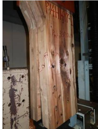
写真 6.4-16 P14H1477-1 試験体スリット部からの開き、1層目～3層目の引張破壊
