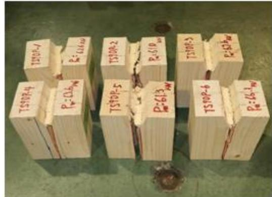
写真 3.5-3 トドマツ TS90P の破壊性状
