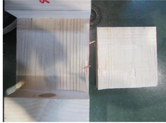
写真 4.4-6 TS60BS-6 試験後の接着面
