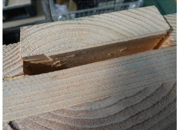
写真 5.4-34 HS9077W-1 座金下部外層ラミナのローリングシア破壊
