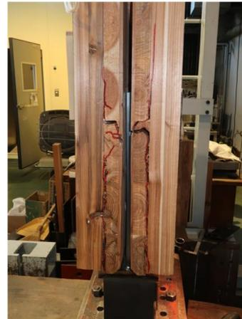
写真 8.4-34 S57D06H 内層のローリングシア破壊
