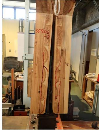
写真 8.4-31 S57D06-3 スリット部からの面外への開き、内層のローリングシア破壊
