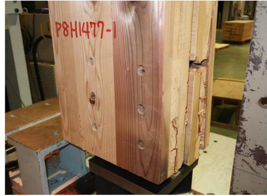
写真 6.4-26 P08H1477-1 内層ラミナの引張破壊
