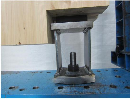
写真 8.4-71 H77D06-3 金物底板の曲げ変形
