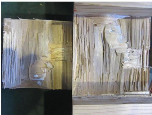
写真 4.4-11 SS60BS-1 試験後の接着面
