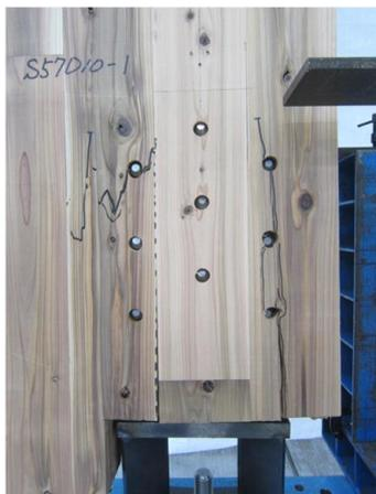
写真 8.4-2 S57D09-1 ピンによる外層ラミナの割裂破壊、外層ラミナの引張破壊
