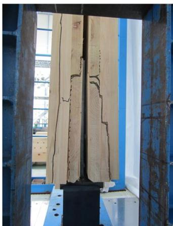
写真 8.4-51 H57D06-1 スリット部からの面外への開き、内層のローリングシア破壊
