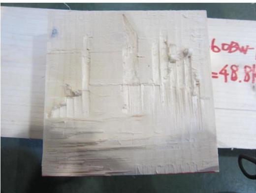
写真 4.4-27 TS60BW-1 試験後の接着面
