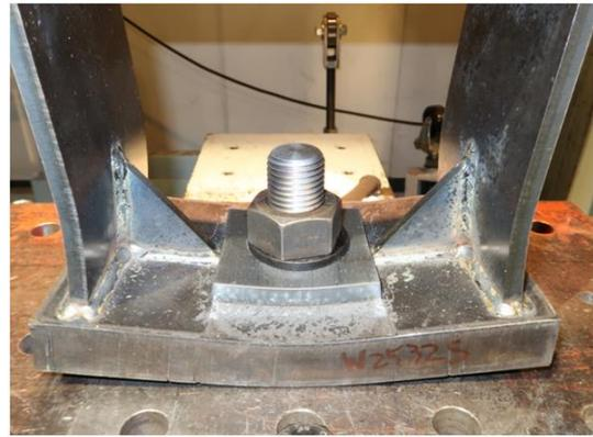
写真 7.4-16 W2532S 底板 D の曲げ変形、側板 C の曲げ変形
