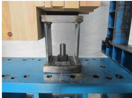
写真 8.4-66 H57D06H 金物底板の曲げ変形
