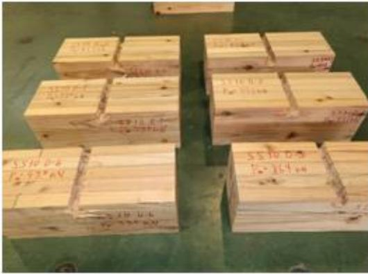
写真 3.5-14 スギ SS300 の破壊性状
