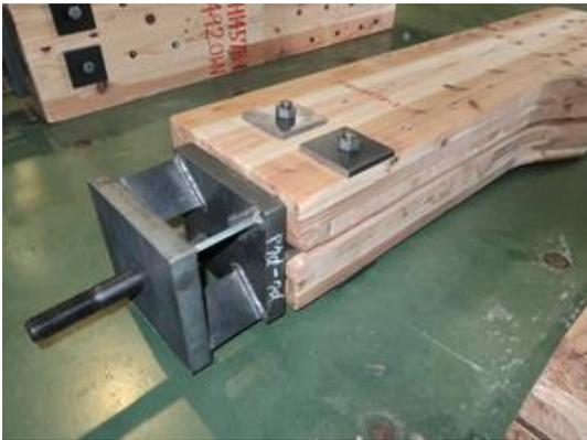
写真 6.4-32 P14H1457B-1 試験機容量到達のため、破壊なし
