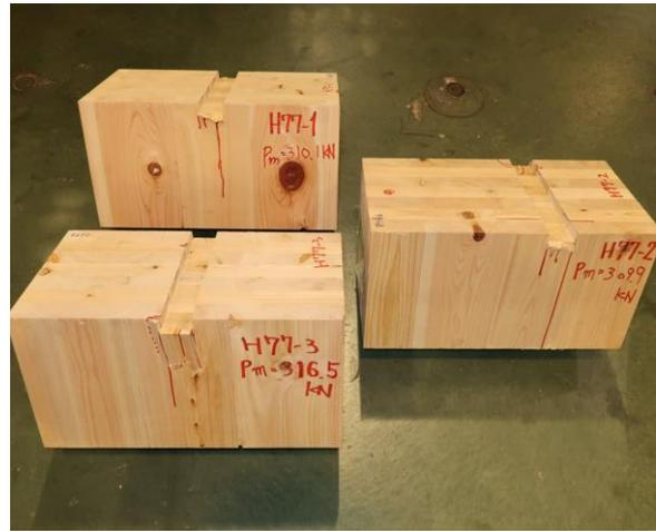
写真 11.2-4 H77 試験後の様子
