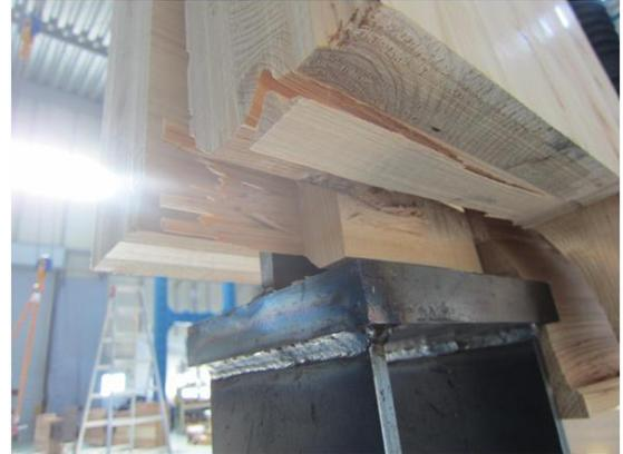
写真 8.4-77 H77D06-H 内層ラミナの引張破壊
