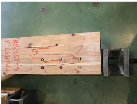
写真 6.4-9 P14H0657-2 ピンによる外層ラミナの割裂破壊
