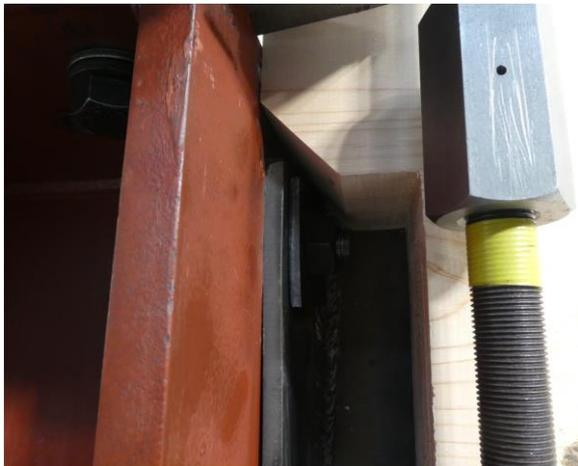
写真 10.4-13 SH57D04-3 ナット及び座金と CLT が接触しないための欠き込み部分
