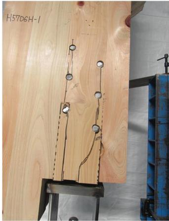
写真 8.4-62 H57D06H ピンによる外層ラミナの割裂破壊
