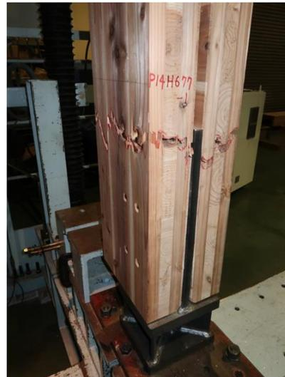
写真 6.4-21 P14H0677-1 CLT の引張破壊
