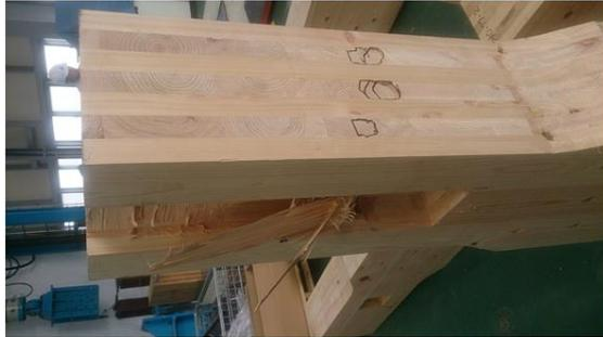
写真 5.4-21 HS9077-1 座金下部外層ラミナのローリングシア破壊
