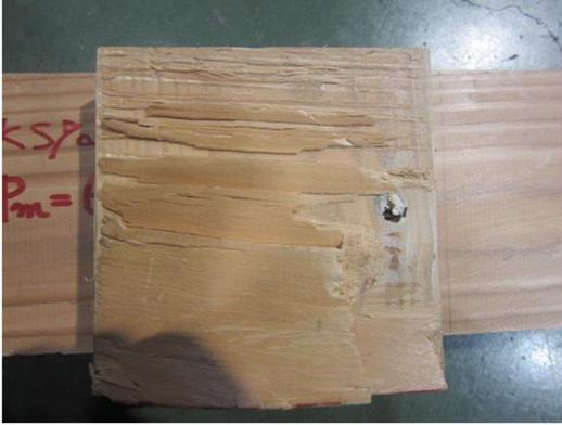
写真 4.4-41 KS90BW-1 試験後の接着面
