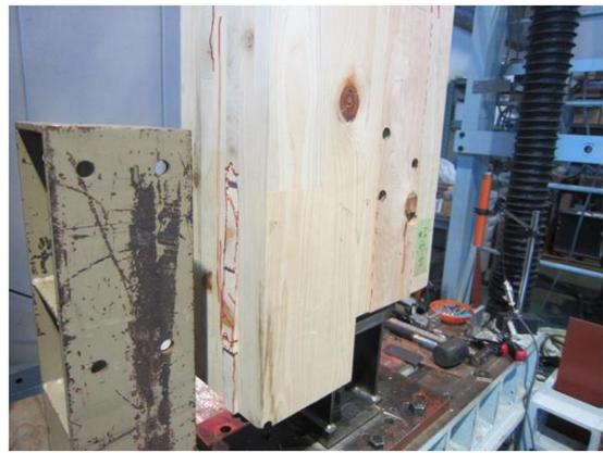
写真 8.4-87 H57D04-H 内層ラミナのローリングシア破壊
