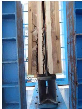
写真 8.4-19 S77D09-6 スリット部からの面外への開き、内層のローリングシア破壊
