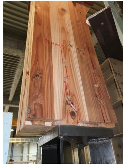
写真 6.4-28 P08H1477-2 ピンによる外層ラミナの割裂破壊, 内層ラミナの引張破壊
