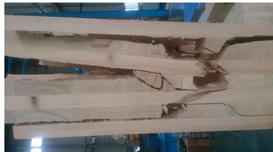
写真 5.4-24 HS9077-2 試験体両脇部分のローリングシア破壊
