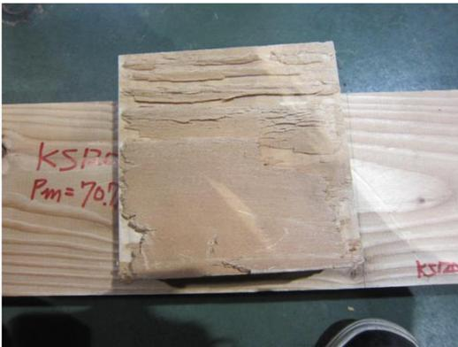
写真 4.4-43 KS120BW-1 試験後の接着面
