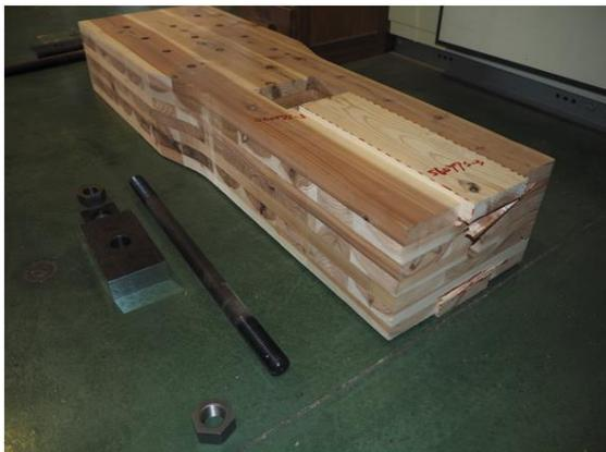
写真 5.4-15 SM6077-3 座金下部外層ラミナのローリングシア破壊
