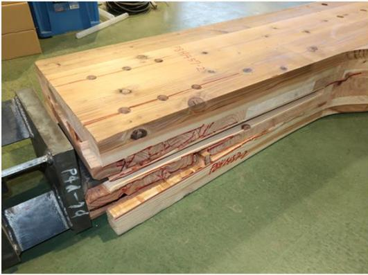
写真 6.4-12 P08H1457-1 内層のローリングシア破壊、ピンによる外層ラミナの割裂破壊
