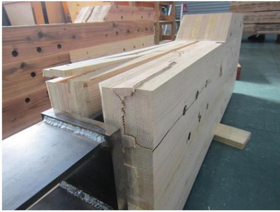
写真 8.4-54 H57D06-1 スリット部からの面外への開き、内層のローリングシア破壊
