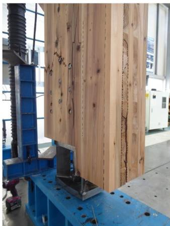
写真 8.4-9 S57D09-5 内層のローリングシア破壊
