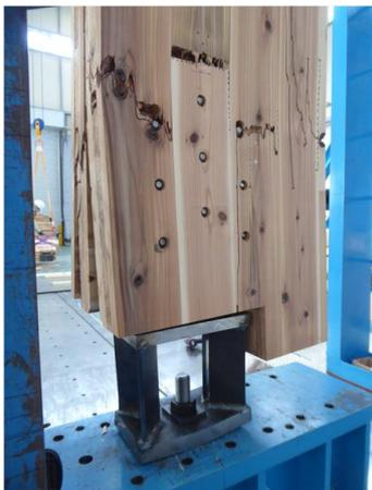
写真 8.4-18 S77D09-5 外層及び外層ラミナの引張破壊、内層のローリングシア破壊
