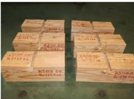
写真 3.5-20 カラマツ KS1200 の破壊性状
