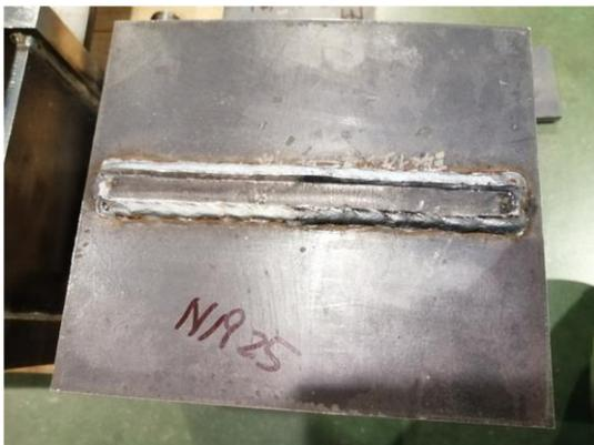
写真 7.4-3 N1925 上板 B 間の溶接部の破断跡
