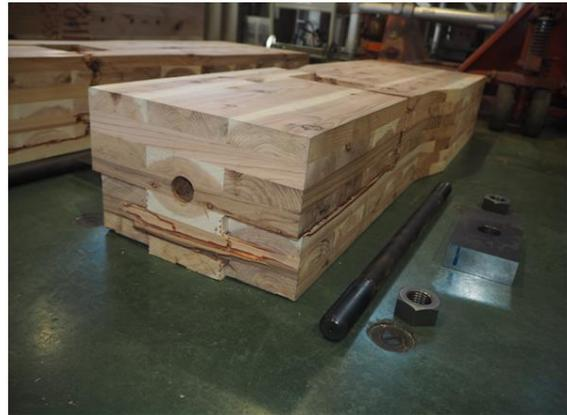
写真 5.4-14 SM6077-1 CLT の引張破壊
