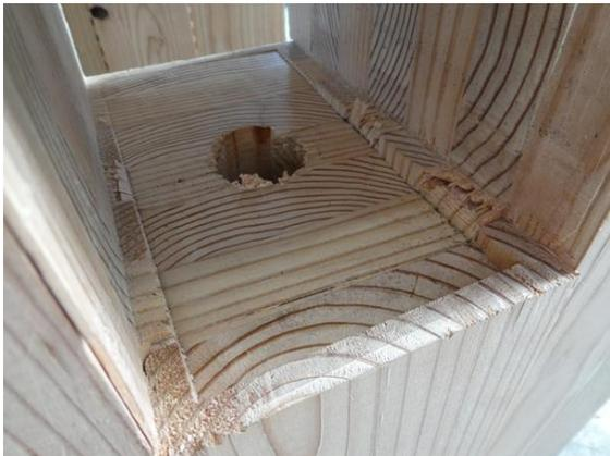
写真 5.4-35 HS9077W-4 座金部分の木材のめり込み変形
