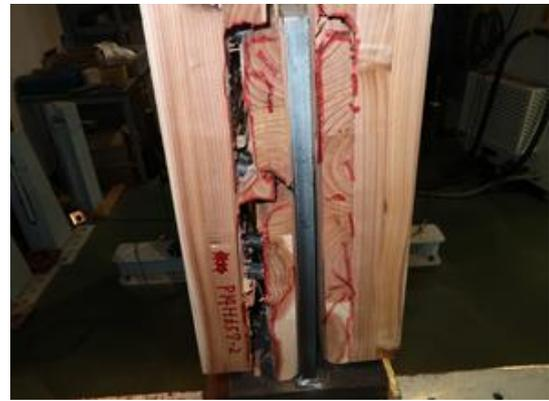
写真 6.4-8 P14H0657-2 内層のローリングシア破壊
