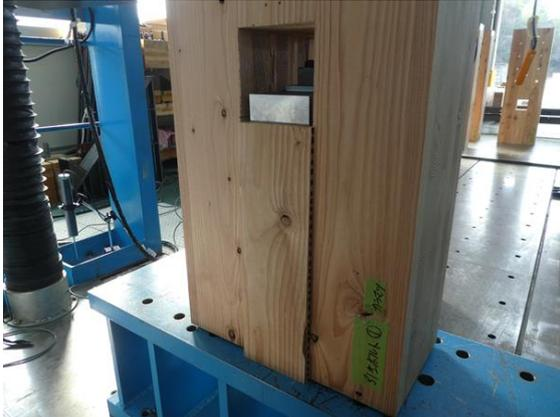
写真 5.4-33 HS9077W-1 座金下部外層ラミナのローリングシア破壊
