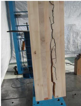
写真 8.4-65 H57D06H 内層のローリングシア破壊
