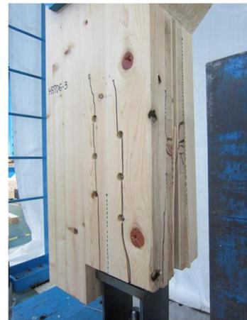
写真 8.4-58 H57D06-3 内層のローリングシア破壊、ピンによる外層ラミナの割裂破壊
