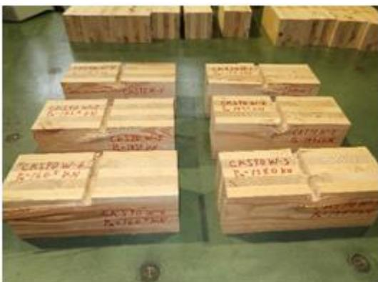
写真 3.5-28 カラマツ CKS90W の破壊性状
