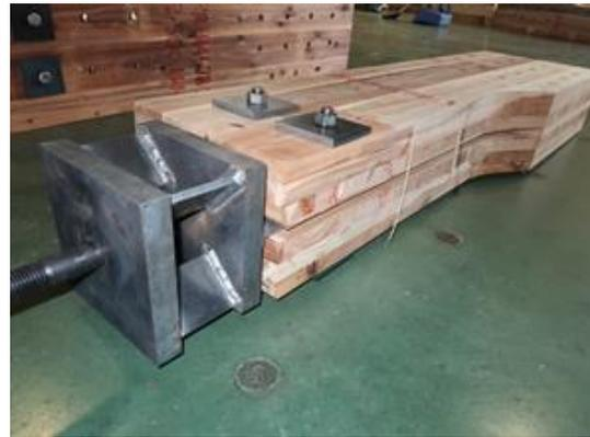
写真 6.4-33 P14H1457B-2 試験機容量到達のため、破壊なし
