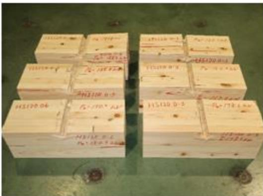
写真 3.5-18 ヒノキ HS1200 の破壊性状
