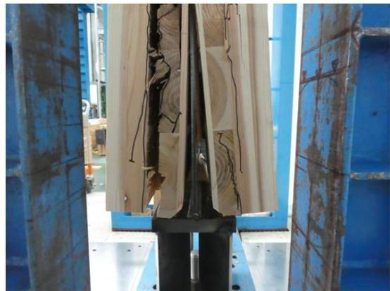
写真 8.4-7 S57D09-3 スリット部からの面外への開き、内層のローリングシア破壊
