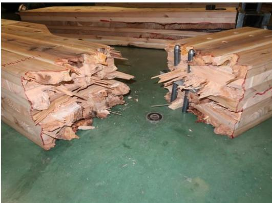
写真 6.4-22 P14H0677-1 CLT の引張破壊
