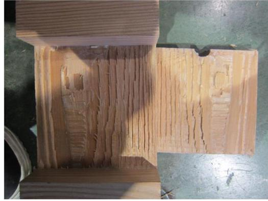
写真 4.4-22 KS120BS-6 試験後の接着面
