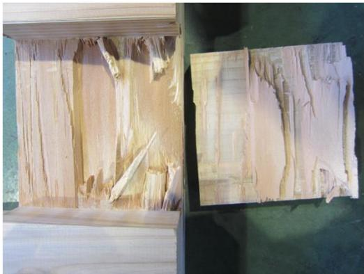
写真 4.4-9 SS30BS-1 試験後の接着面
