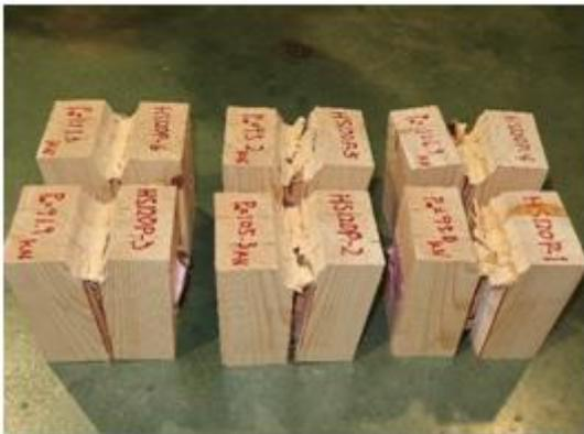
写真 3.5-8 ヒノキ HS120P の破壊性状
