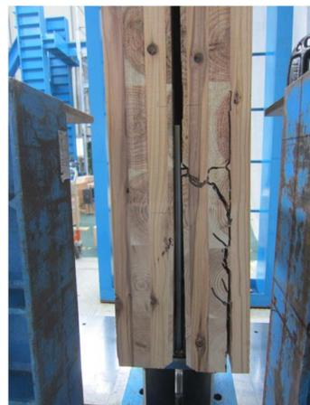
写真 8.4-14 S77D09-1 内層のローリングシア破壊、内層ラミナの引張破壊
