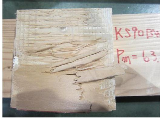
写真 4.4-42 KS90BW-6 試験後の接着面
