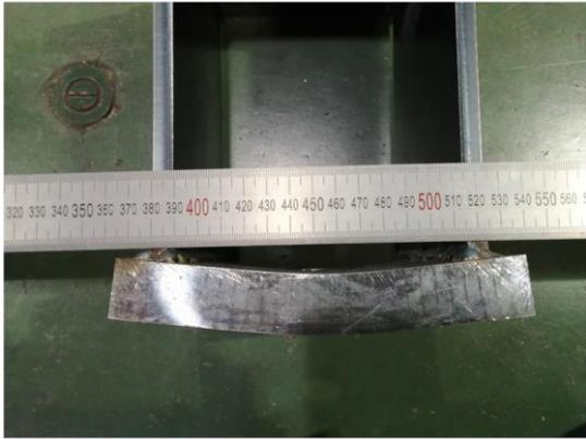
写真 7.4-5 N1925 底板 D の曲げ変形
