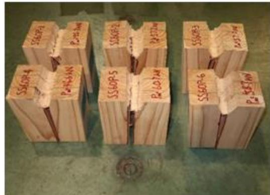
写真 3.5-5 スギ SS60P の破壊性状
