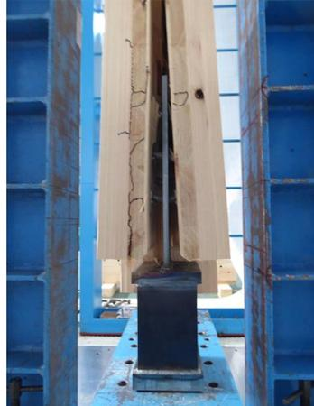
写真 8.4-61 H57D06-5 スリット部からの面外への開き、内層のローリングシア破壊
