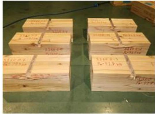
写真 3.5-15 スギ SS600 の破壊性状
