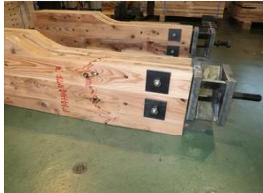
写真 6.4-52 P14H1477B-3 CLT の引張破壊
