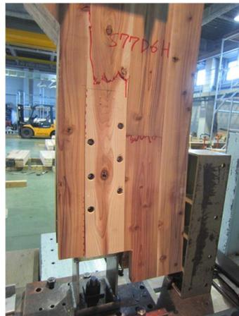
写真 8.4-48 S77D06H スリット部からの面外への開き、それに伴うラミナの割れ(引張破壊ではない)
