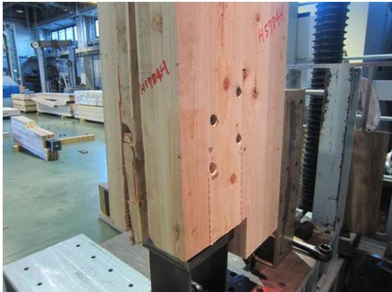
写真 8.4-88 H57D04-H スリット部からの面外への開き、内層ラミナのローリングシア破壊
