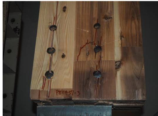
写真 6.4-15 P08H1457-3 内層のローリングシア破壊、ピンによる外層ラミナの割裂破壊
