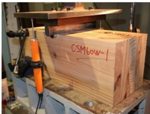
写真 3.3-2 CLT の試験
