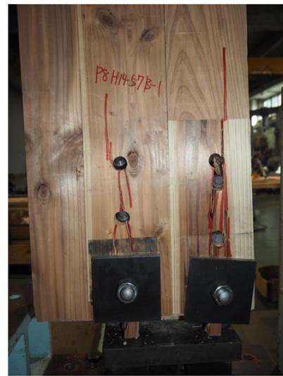
写真 6.4-41 P08H1457B-1 内層のローリングギア破壊、ピンによる外層ラミナの割裂破壊、ピンによる外層ラミナの押し抜きせん断破壊
