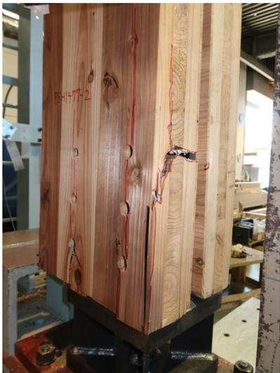
写真 6.4-29 P08H1477-2 ピンによる外層ラミナの割裂破壊, 内層ラミナの引張破壊
