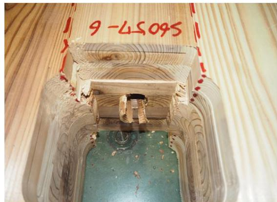
写真 5.4-4 SM6057R-6 座金下部外層ラミナのローリングシア破壊
