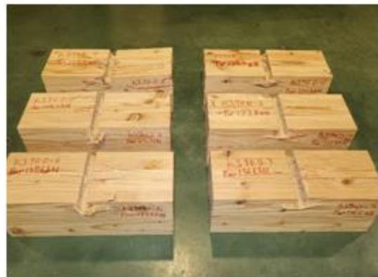
写真 3.5-19 カラマツ KS900 の破壊性状
