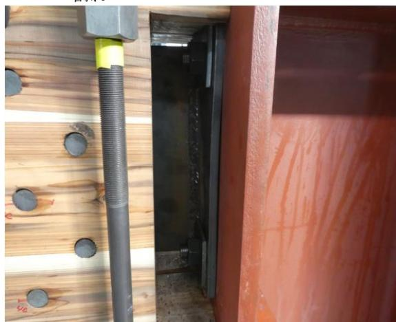
写真 10.4-3 SS57D05-2 CLT と座金の接触による荷重増加
