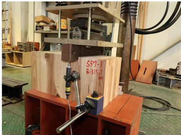
写真 11.1-1 CLT の部分圧縮試験
