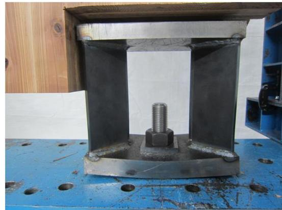
写真 8.4-12 S77D09-1 金物底板の曲げ変形
