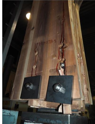
写真 6.4-45 P08H1457B-3 内層のローリングシア破壊、ピンによる外層ラミナの割裂破壊、ピンによる外層ラミナの押し抜きせん断破壊
