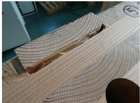
写真 5.4-36 HS9077W-1 座金下部外層ラミナのローリングシア破壊
