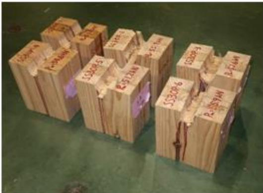
写真 3.5-4 スギ SS30P の破壊性状
