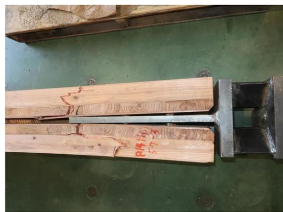
写真 6.4-10 P14H0657-3 ピンによる外層ラミナの割裂破壊
