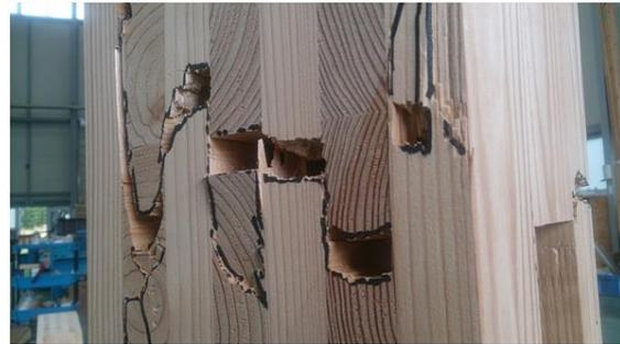
写真 5.4-26 KS9077-1 CLT の引張破壊
