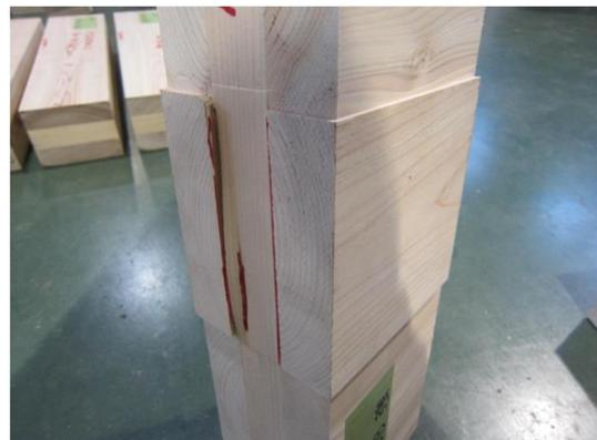
写真 4.4-6 外層加力試験 試験後の様子
