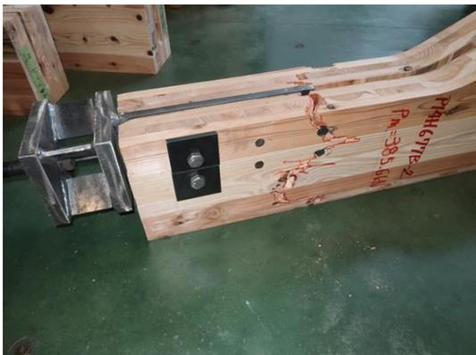
写真 6.4-56 P14H0677B-2 CLT の引張破壊
