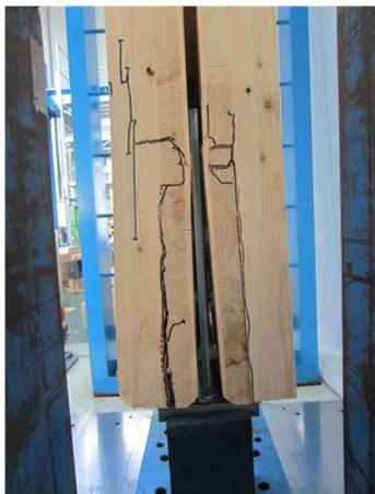
写真 8.4-56 H57D06-1 スリット部からの面外への開き、内層のローリングシア破壊
