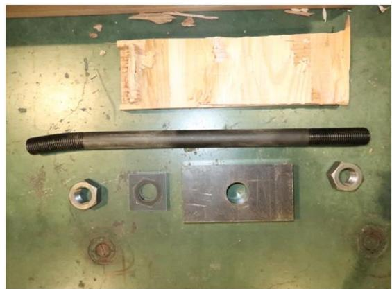
写真 5.4-32 SM6077W-5 試験後のボルト・ナット、座金
