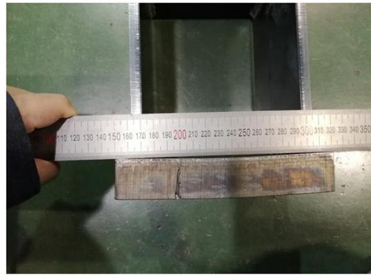
写真 7.4-8 N2532 底板 D の曲げ変形
