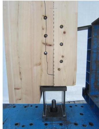
写真 8.4-55 H57D06-2 ピンによる外層ラミナの割裂破壊
