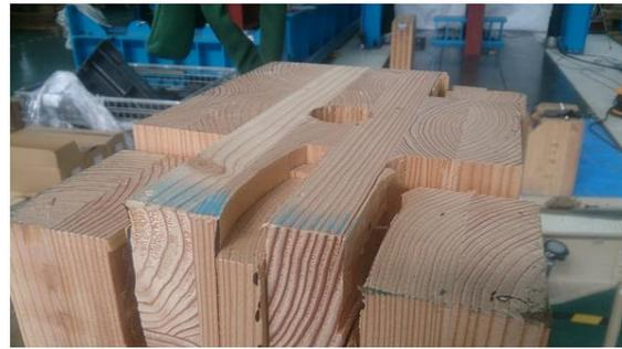
写真 5.4-10 KS9057-3 試験体両脇部分のローリングシア破壊
