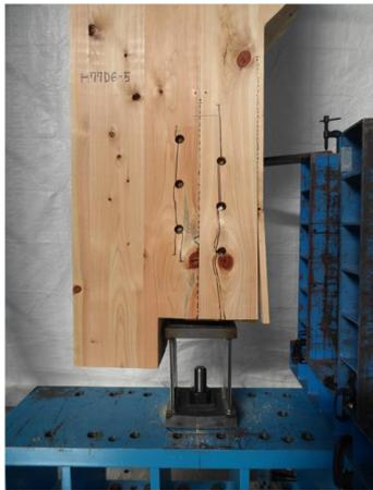
写真 8.4-73 H77D06-5 ピンによる外層ラミナの割裂破壊
