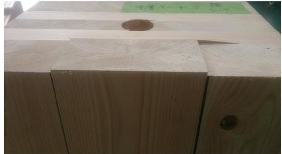
写真 5.4-6 HS9057-1 座金下部外層ラミナのローリングシア破壊
