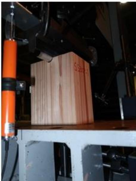
写真 3.3-1 集成材の繊維方向試験
