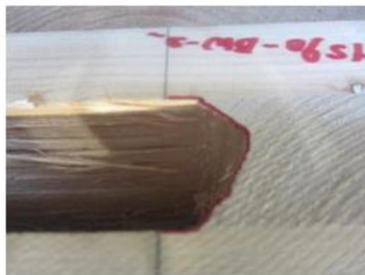
写真 4.5-2 幅方向の接着
