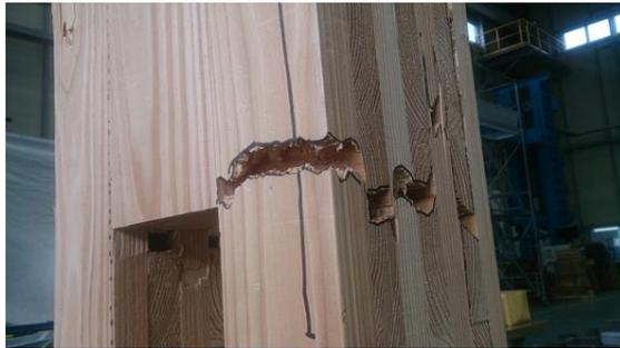
写真 5.4-25 KS9077-1 CLT の引張破壊
