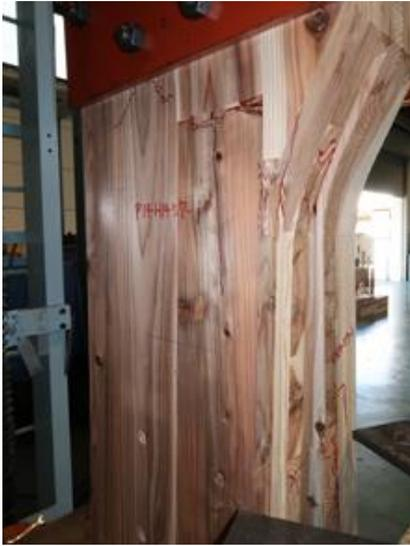
写真 6.4-2 P14H1457-1 試験体スリット部からの開き、それに伴う外層の割れ
