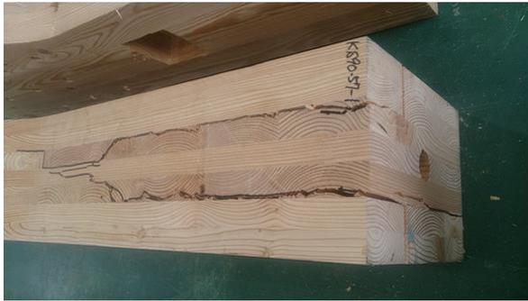
写真 5.4-9 KS9057-1 試験体両脇部分のローリングシア破壊
