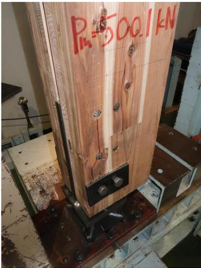
写真 6.4-35 P14H0657B-1 外層に若干の割れあり(ただし、試験体としては破壊に至っていない)
