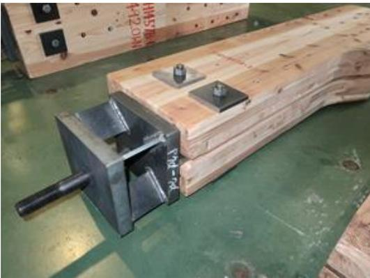
写真 6.4-49 P14H1477B-1 破壊なし
