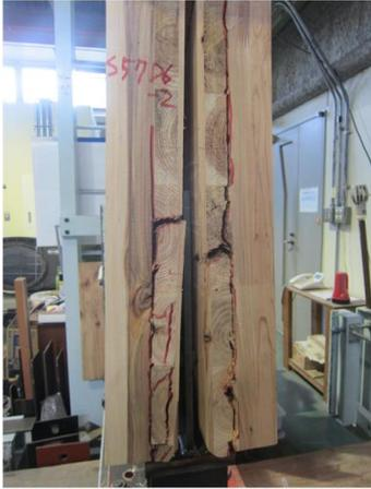
写真 8.4-30 S57D06-2 スリット部からの面外への開き、内層のローリングシア破壊
