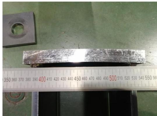
写真 7.4-4 N1925 上板 B の曲げ変形
