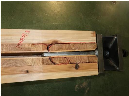
写真 6.4-14 P08H1457-3 内層のローリングシア破壊、ピンによる外層ラミナの割裂破壊
