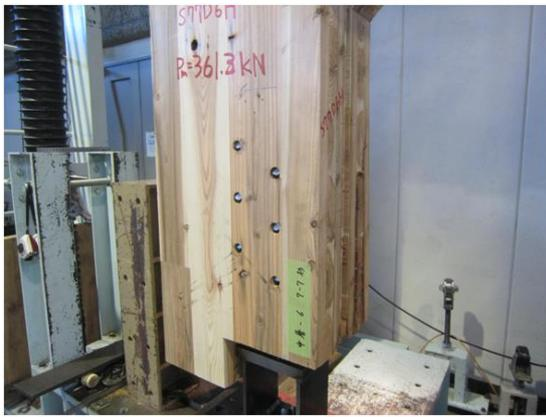
写真 8.4-45 S77D06-H スリット部からの面外への開き、内層のローリングシア破壊
