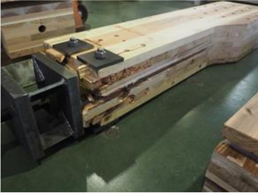
写真 6.4-63 P08H1477B-2 内層のローリングシア破壊、ピンによる外層ラミナの割裂破壊、ピンによる外層ラミナの押し抜きせん断破壊、内層ラミナの引張破壊
