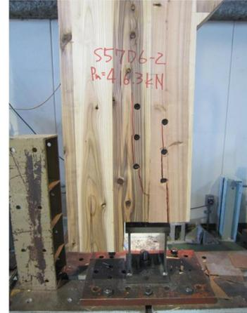
写真 8.4-25 S57D06-2 ピンによる外層ラミナの割裂破壊
