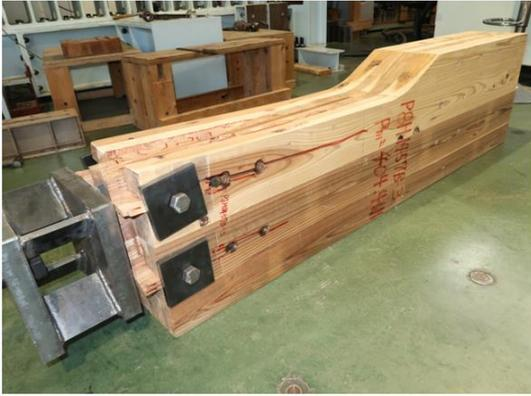
写真 6.4-46 P08H1457B-3 内層のローリングシア破壊、ピンによる外層ラミナの割裂破壊、ピンによる外層ラミナの押し抜きせん断破壊
