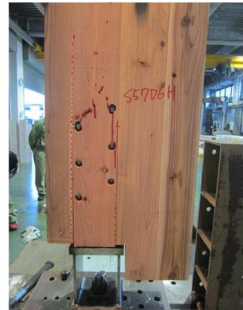
写真 8.4-35 S57D06H ピンによる外層ラミナの割裂破壊、外層ラミナの引張破壊
