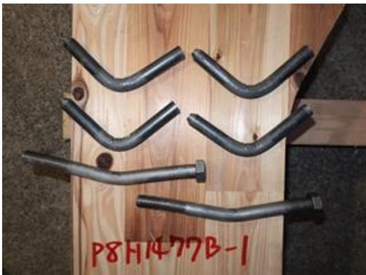
写真 6.4-61 P08H1477B-1 ピン及びボルトの曲げ変形、
