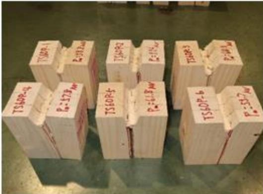
写真 3.5-2 トドマツ TS60P の破壊性状
