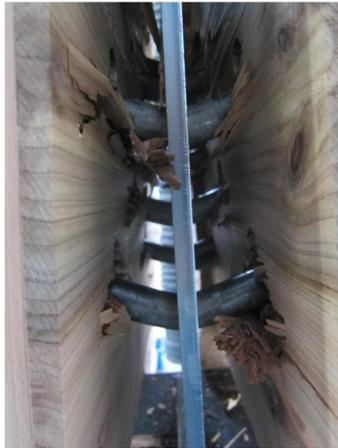
写真 8.4-16 S77D09-2 スリット部からの面外への開き、ドリフトピンの曲げ変形の様子
