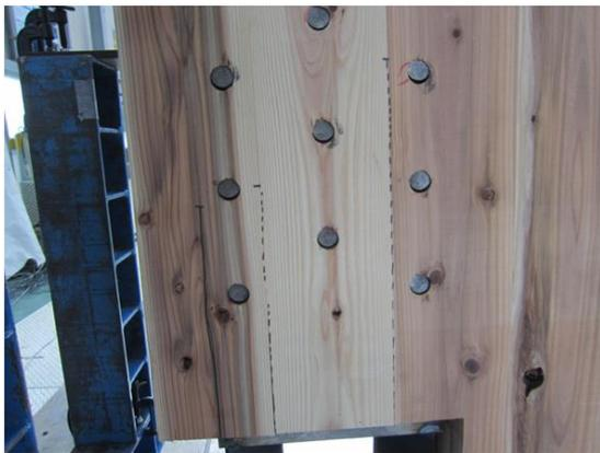
写真 8.4-6 S57D09-2 裏面はピンによる外層ラミナの割裂破壊はなし
