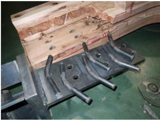
写真 6.4-7 P14H0657-1 内層のローリングシア、ドリフトピンの曲げ変形
