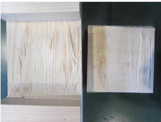
写真 4.4-17 HS120BS-1 試験後の接着面
