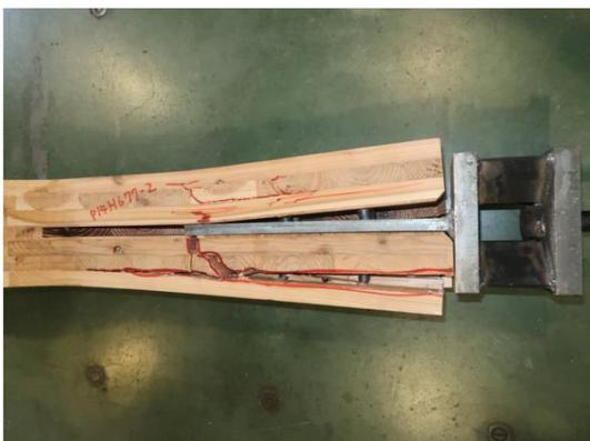
写真 6.4-24 P14H0677-2 内層のローリングシア破壊、内層ラミナの引張破壊
