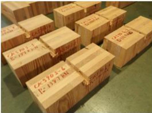
写真 3.5-24 カラマツ CKS90S の破壊性状
