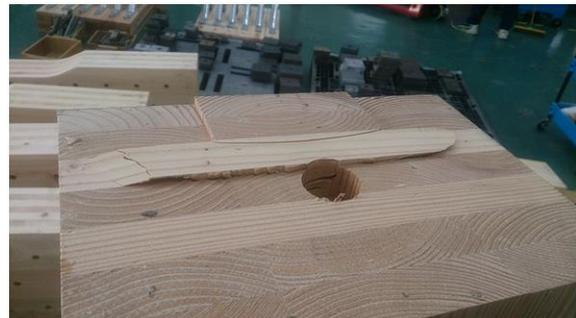
写真 5.4-12 KS9057-2 座金下部外層ラミナのローリングシア破壊
