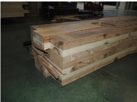
写真 5.4-3 SM6057R-3 座金下部外層ラミナのローリングシア破壊
