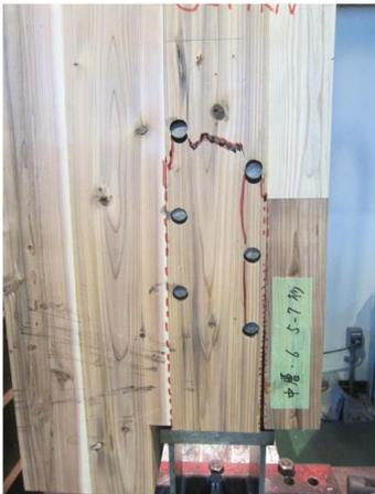
写真 8.4-33 S57D06H ピンによる外層ラミナの割裂破壊、外層ラミナの引張破壊
