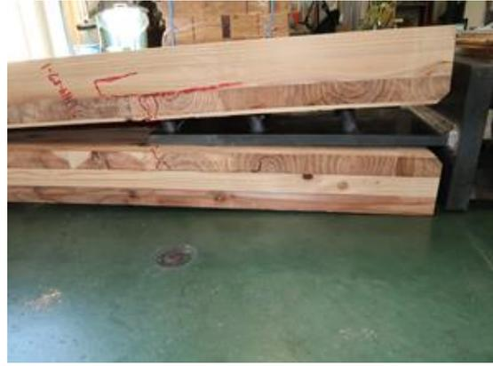
写真 6.4-1 P14H1457-1 試験体スリット部からの開き、3、5層目の割れ
