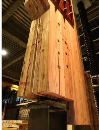
写真 8.4-24 S57D06-1 内層のローリングシア破壊、ピンによる外層ラミナの割裂破壊
