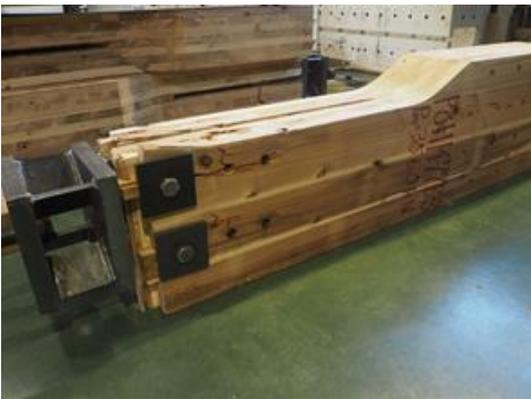
写真 6.4-67 P08H1477B-3 内層のローリングシア破壊、ピンによる外層ラミナの割裂破壊、ピンによる外層ラミナの押し抜きせん断破壊、内層ラミナの引張破壊
