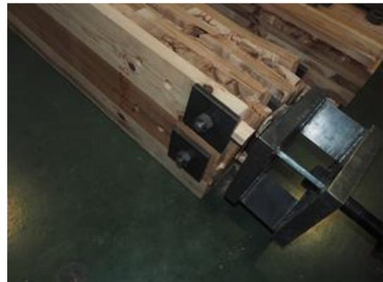
写真 6.4-68 P08H1477B-3 内層のローリングシア破壊、ピンによる外層ラミナの割裂破壊、ピンによる外層ラミナの押し抜きせん断破壊、内層ラミナの引張破壊
