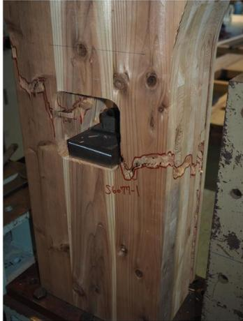
写真 5.4-17 SM6077R-1 CLT の引張破壊
