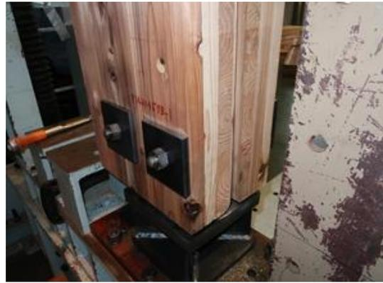
写真 6.4-31 P14H1457B-1 試験機容量到達のため、破壊なし
