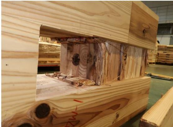
写真 5.4-29 SM6077W-1 座金下部外層ラミナのローリングシア破壊
