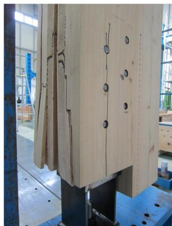
写真 8.4-52 H57D06-1 内層のローリングシア破壊、ピンによる外層ラミナの割裂破壊
