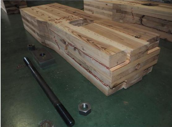
写真 5.4-1 SM6057R-1 試験体両脇部分のローリングシア破壊
