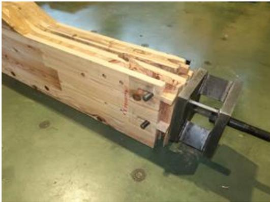
写真 6.4-59 P08H1477B-1 内層のローリングシア破壊、ピンによる外層ラミナの割裂破壊、ピンによる外層ラミナの押し抜きせん断破壊、内層ラミナの引張破壊
