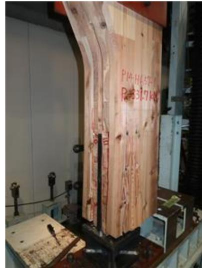
写真 6.4-6 P14H0657-1 内層のローリングシア破壊、ピンによる外層ラミナの割裂破壊
