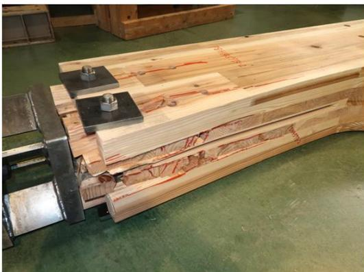
写真 6.4-42 P08H1457B-2 内層のローリングギア破壊、ピンによる外層ラミナの割裂破壊、ピンによる外層ラミナの押し抜きせん断破壊
