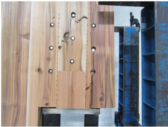
写真 8.4-4 S57D09-2 ピンによる外層ラミナの割裂破壊、外層ラミナの引張破壊
