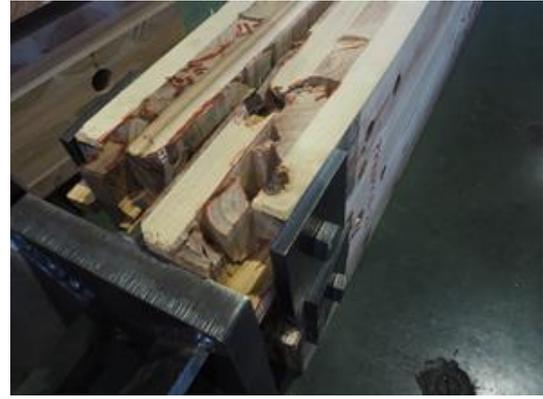
写真 6.4-64 P08H1477B-2 内層のローリングシア破壊、ピンによる外層ラミナの割裂破壊、ピンによる外層ラミナの押し抜きせん断破壊、内層ラミナの引張破壊
