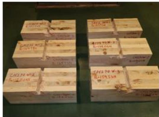
写真 3.5-27 ヒノキ CHS90 W の破壊性状
