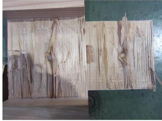
写真 4.4-14 SS90BS-6 試験後の接着面
