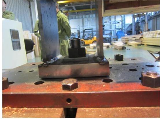
写真 8.4-44 S77D06-3 金物底板の曲げ変形
