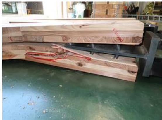
写真 6.4-5 P14H1457-3 試験体スリット部からの開き
