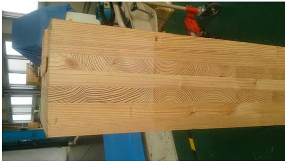
写真 5.4-11 KS9057-2 座金下部外層ラミナのローリングシア破壊
