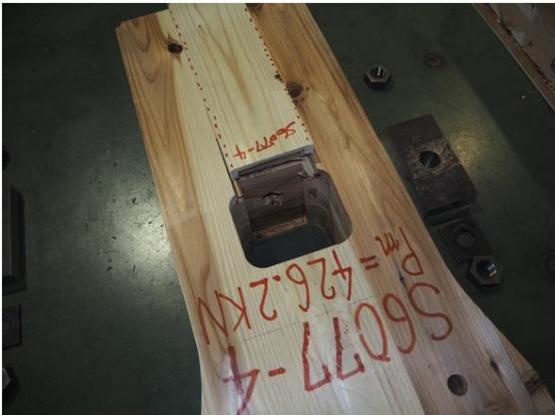
写真 5.4-19 SM6077R-4 座金下部外層ラミナのローリングシア破壊
