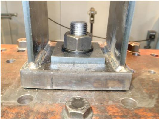
写真 7.4-7 N2532 底板 D の曲げ変形
