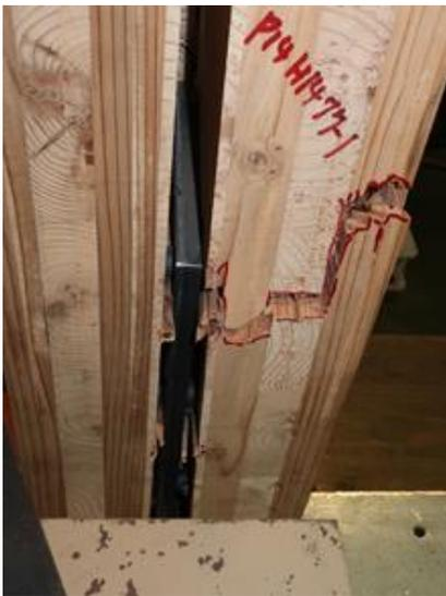
写真 6.4-17 P14H1477-1 試験体スリット部からの開き、1層目～3層目の引張破壊
