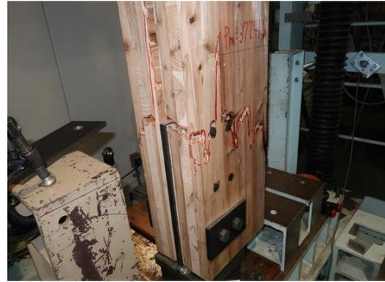
写真 6.4-53 P14H0677B-1 CLT の引張破壊
