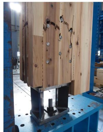
写真 8.4-10 S57D09H ピンによる外層ラミナの割裂破壊、外層ラミナの引張破壊
