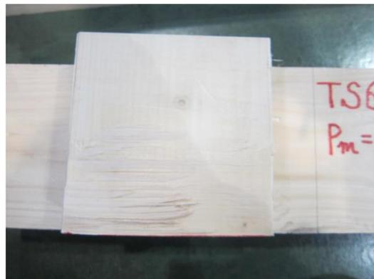
写真 4.4-28 TS60BW-6 試験後の接着面
