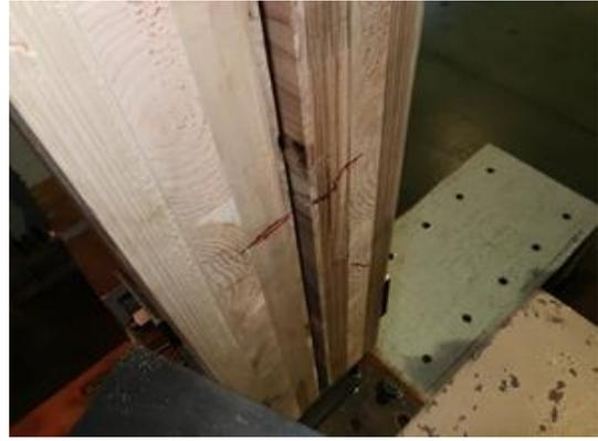
写真 6.4-48 P14H1477B-1 3層目、5層目に若干の割れあり (ただし、試験体としては破壊に至っていない)
