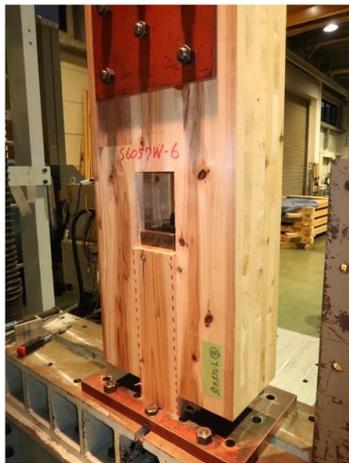
写真 5.4-31 SM6077W-6 座金下部外層ラミナのローリングシア破壊
