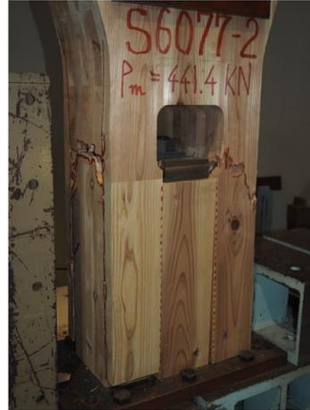
写真 5.4-18 SM6077R-2 CLT の引張破壊
