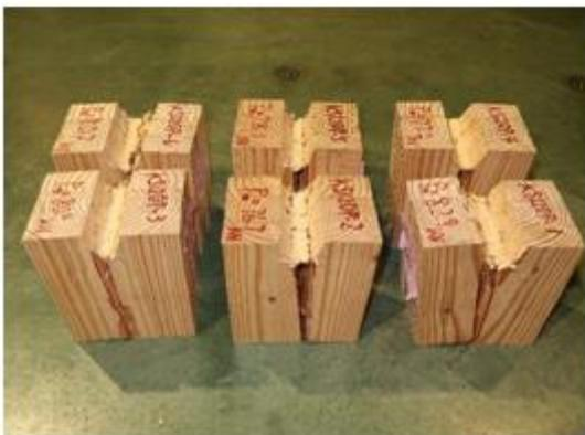
写真 3.5-10 カラマツ KS120P の破壊性状
