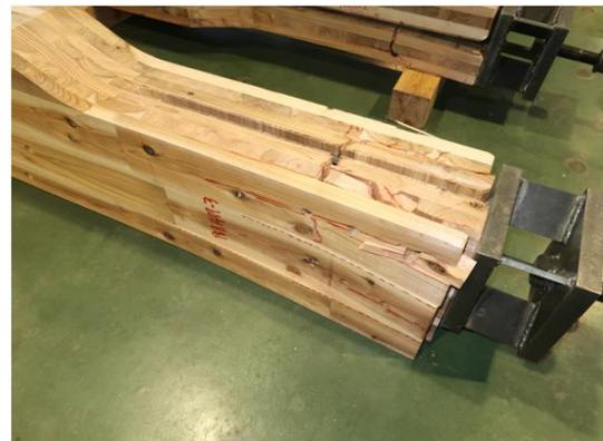
写真 6.4-30 P08H1477-3 内層ラミナの引張破壊
