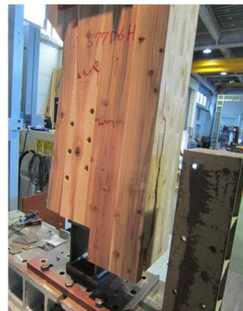
写真 8.4-49 S77D06H スリット部からの面外への開き、それに伴うラミナの割れ(引張破壊ではない)
