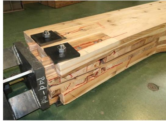
写真 6.4-39 P08H1457B-1 内層のローリングギア破壊、ピンによる外層ラミナの割裂破壊、ピンによる外層ラミナの押し抜きせん断破壊
