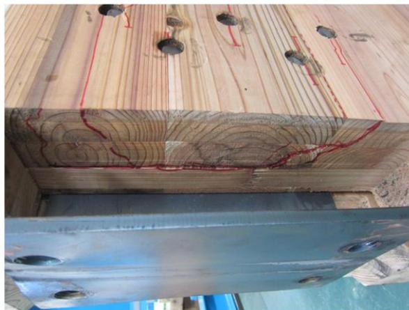
写真 10.4-5 SS57D05-3 ドリフトピンに沿った割れに伴う 2-3 プライ間のローリングシア破壊
