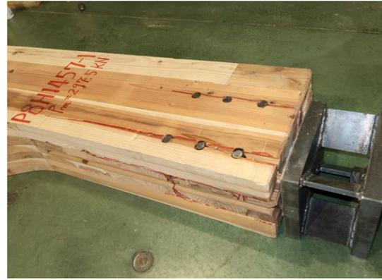
写真 6.4-11 P08H1457-1 内層のローリングシア破壊、ピンによる外層ラミナの割裂破壊
