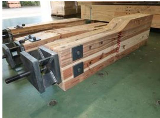
写真 6.4-50 P14H1477B-2 破壊なし
