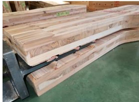
写真 6.4-20 P14H1477-3 試験体スリット部からの開き
