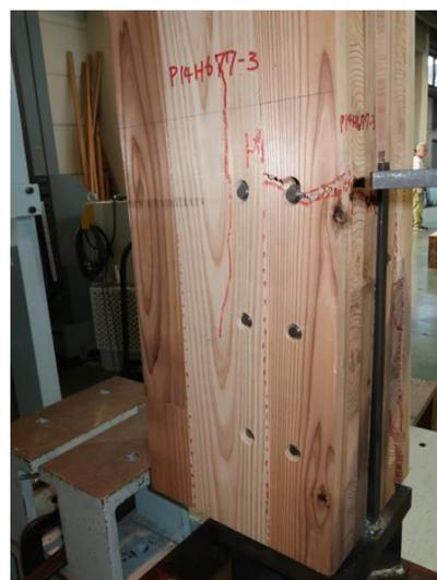
写真 6.4-25 P14H0677-3 内層のローリングシア破壊、内層ラミナの引張破壊
