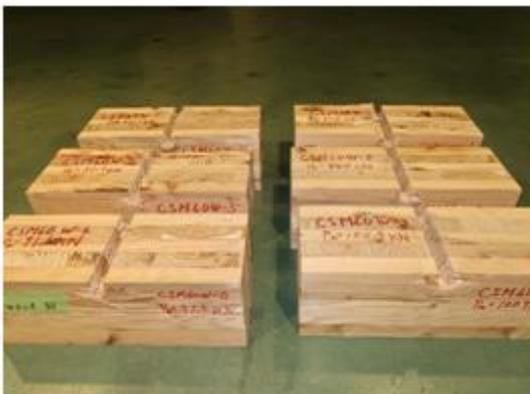
写真 3.5-26 スギ CSM60W の破壊性状
