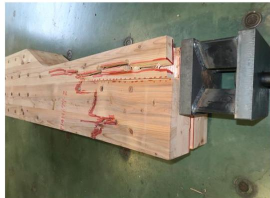
写真 6.4-23 P14H0677-2 内層のローリングシア破壊、内層ラミナの引張破壊
