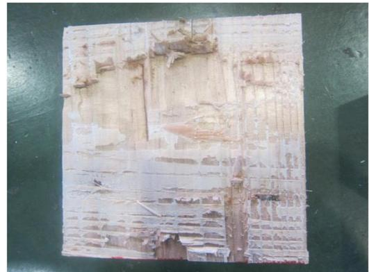
写真 4.4-34 SS60BW-6 試験後の接着面
