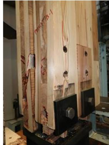
写真 6.4-58 P08H1477B-1 内層のローリングシア破壊、ピンによる外層ラミナの割裂破壊、ピンによる外層ラミナの押し抜きせん断破壊、内層ラミナの引張破壊
