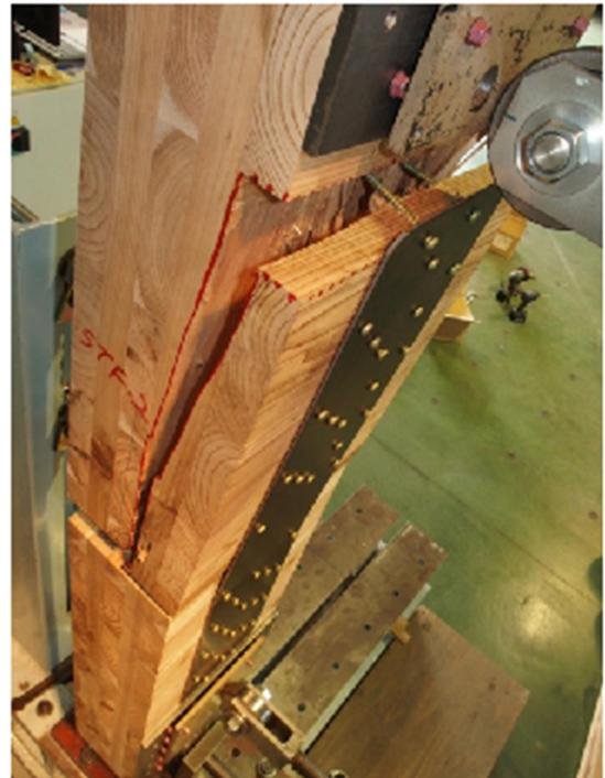
写真 3.4-91 試験体 O3041-1 試験後
