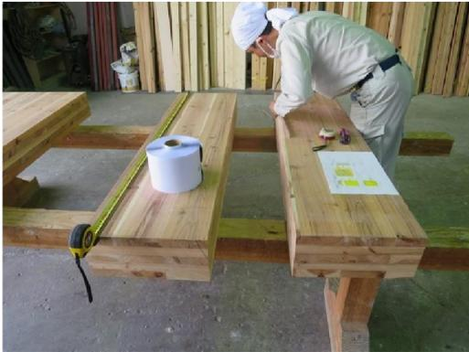
写真 5.2-2 CLT 精度のチェック
