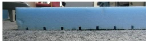
写真 8.2.3-6 通気溝付勾配断熱材断面
