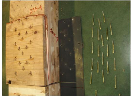
写真 3.4-104 試験体 O3041-4 解体後
