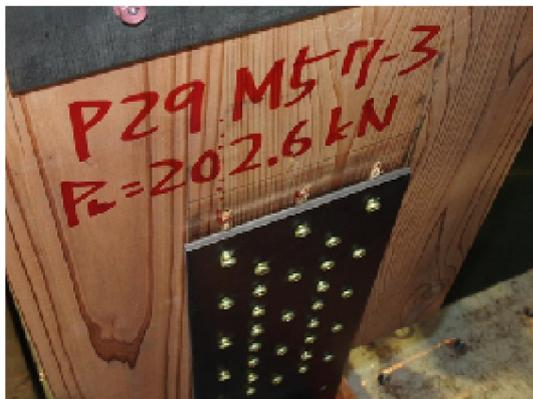
写真 3.4-9 試験体 P29M57-65-3
