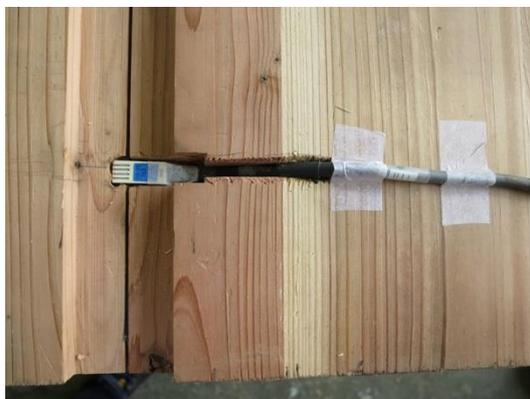
写真 6.3-3-1 温度センサー取付
