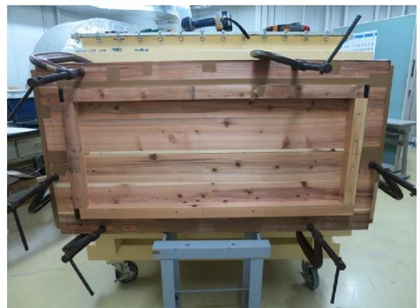
写真 5.3-8 試験体 (CLT のみ)
