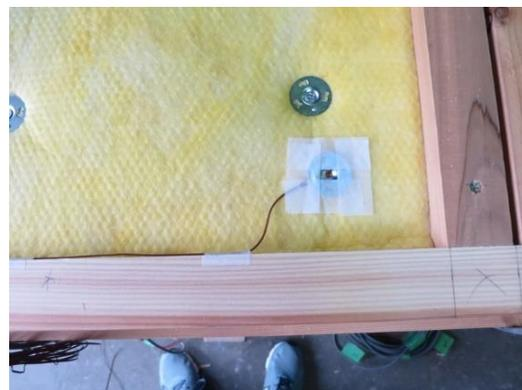
写真 6.3-3-2 温度センサー取付（屋外側）
