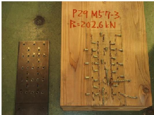
写真 3.4-11 試験体 P29M57-65-3
