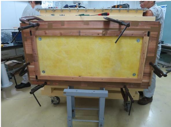
写真 5.3-7 試験体 (CLT+グラスウール)
