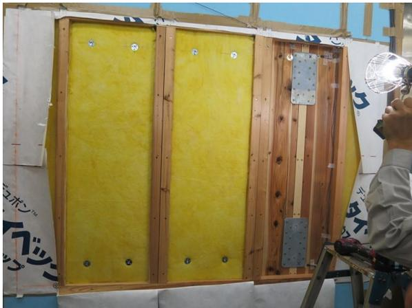
写真 6.4-11 試験終了後の試験体解体
