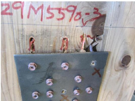
写真 3.4-33 試験体 P29M55-90-3
