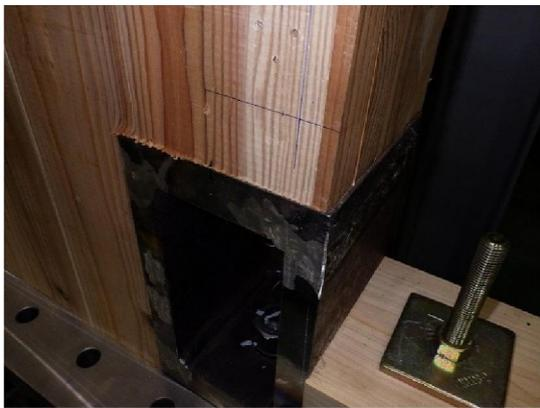
写真 3-4 試験終了の CLT 壁下部の箱型
