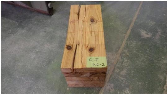
写真 4-7-2 試験終了時の土台の割れ
