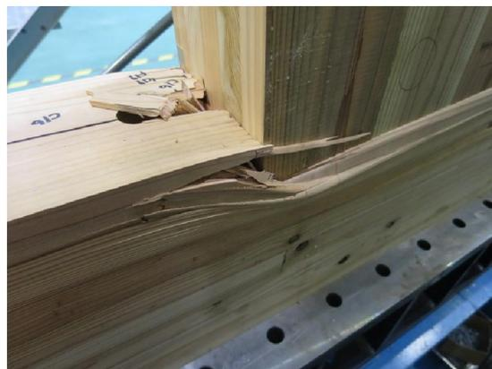
写真 3-18 下部横架材の終局時のめり込み状況
