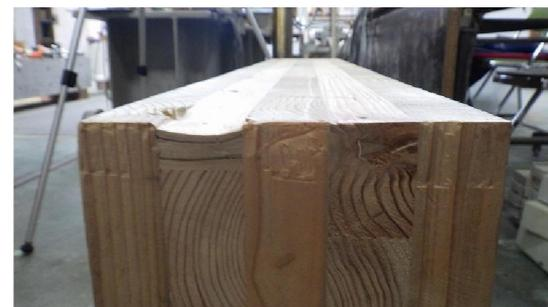
写真 4-15-4 CLT の変位状況
