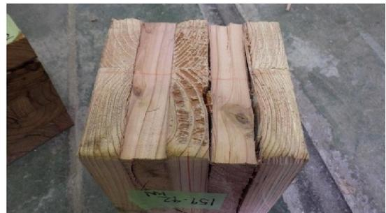
写真 4-7-3 CLT 下部の破壊状況
