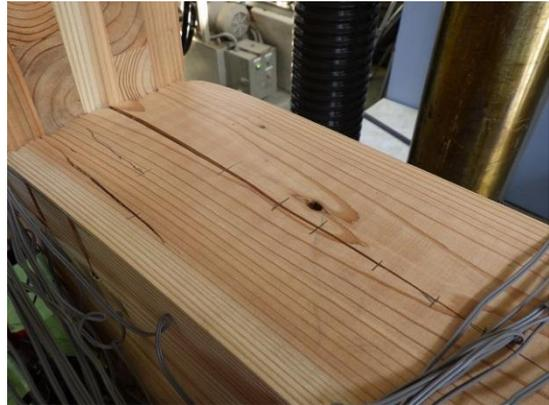
写真 4-13-2 試験終了時の土台の割れ
