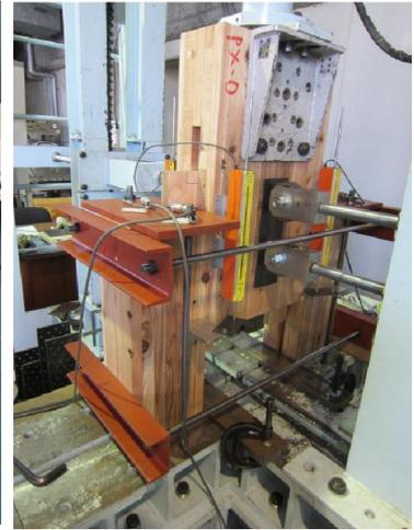
写真 1-2 横架材と CLT のせん断試験
