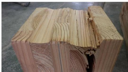
写真 4-12-3 CLT 下部の破壊状況
