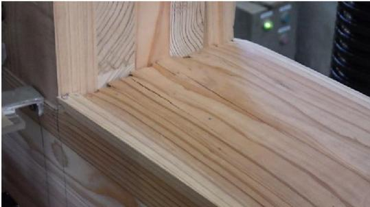
写真 4-14-1 試験終了時の土台の割れ
