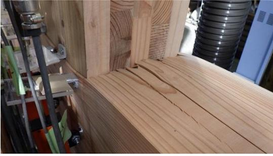
写真 4-18-1 試験終了時の土台の割れ
