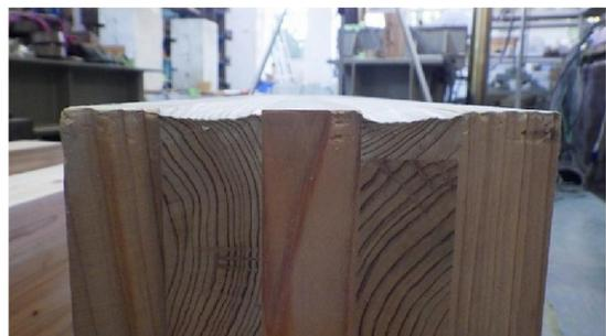
写真 4-14-4 CLT の変位状況
