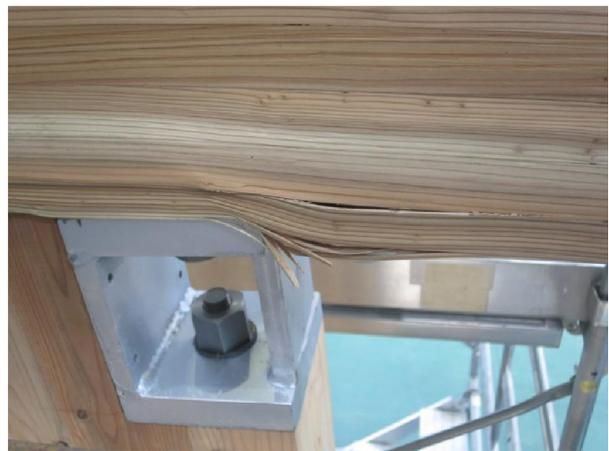
写真 3-45 試験終了時の梁集成材への
