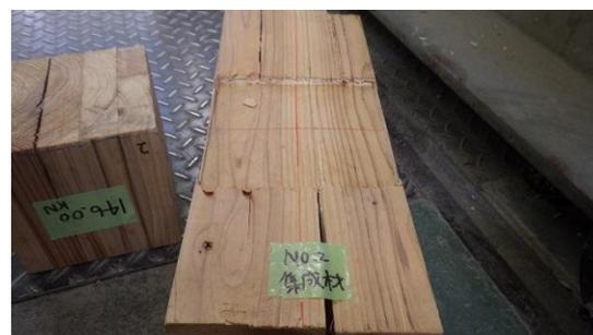
写真 4-3-2 試験終了時の土台の割れ
