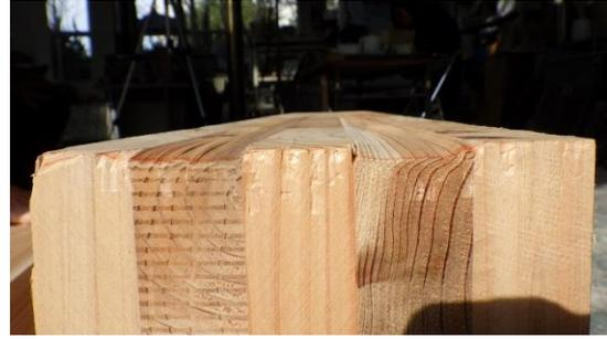
写真 4-18-4 CLT の変位状況
