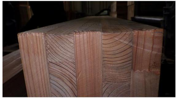
写真 4-20-3 CLT の変位状況
