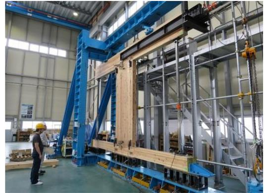
写真 1-3 横架材+CLT の構面試験
