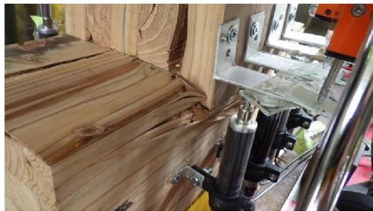
写真 4-6-1 試験終了時の土台へのめり込み状況
