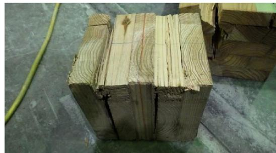
写真 4-8-3 CLT 下部の破壊状況
