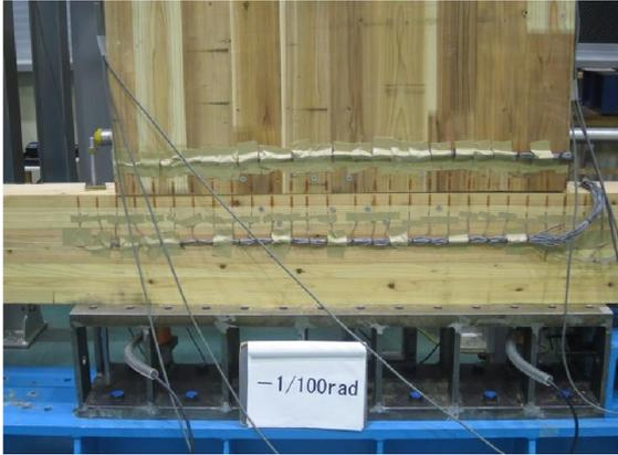
写真 3-19 下部横架材部のひずみゲージの取り付け状況
