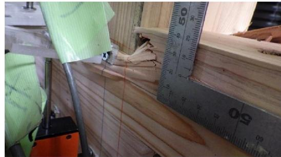
写真 4-15-2 試験終了時の土台へのめり込み
