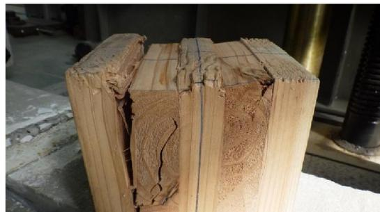
写真 4-6-3 CLT 下部の破壊状況
