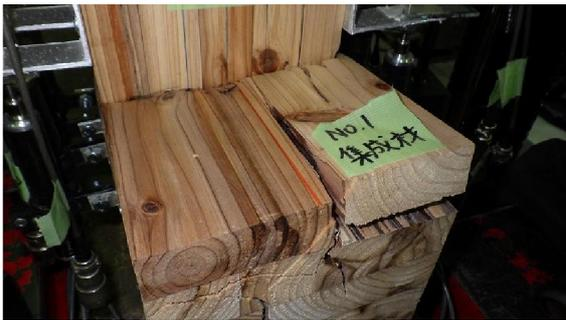
写真 4-2-1 試験終了時の土台の割れ
