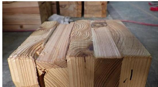
写真 4-10-3 CLT 下部の破壊状況
