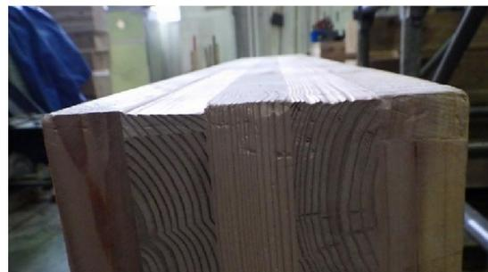
写真 4-3-12 CLT の変位状況
