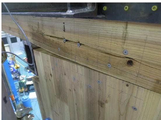
写真 3-17 せん断キーの回転による横架材の横引張による割れ
