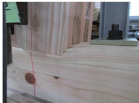
写真 1-4 CLT の横架材へのめり込み
