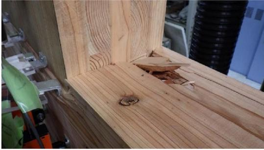
写真 4-15-1 試験終了時の土台の割れ
