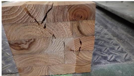
写真 4-4-3 試験終了時の土台集成材の割れ
