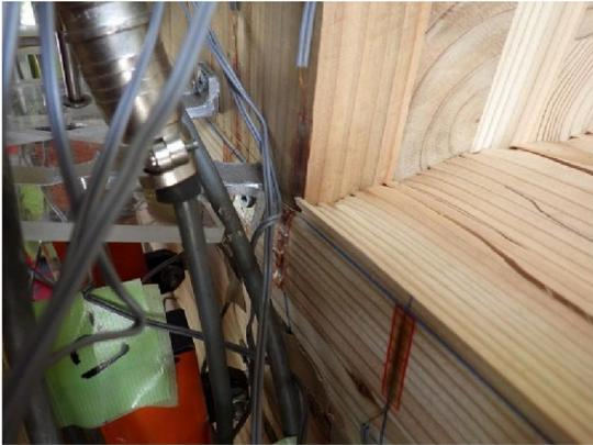
写真 4-13-1 試験終了時の土台へのめり込み
