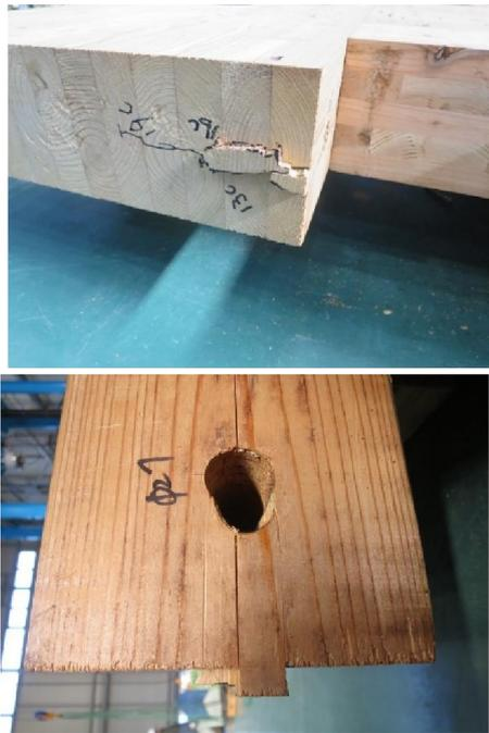
写真 3-16 端部仕様試験体の横架材の木口部の破断
