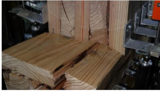
写真 4-7-1 試験終了時の土台へのめり込み状況
