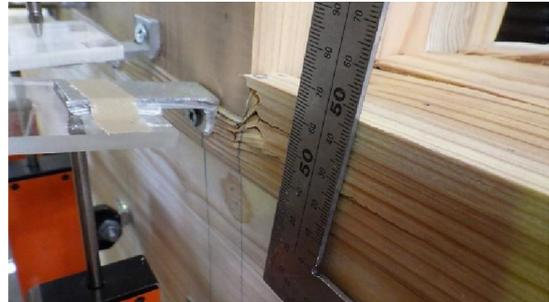
写真 4-14-2 試験終了時の土台へのめり込み
