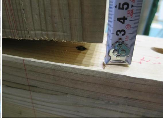
写真 3-20 終局時の CLT 下部の浮き上がり
