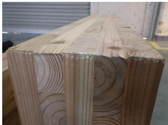
写真 4-13-4 CLT の変位状況
