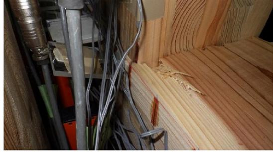
写真 4-16-1 試験終了時の土台の割れ 写真 4-16-2 試験終了時の土台へのめり込み
