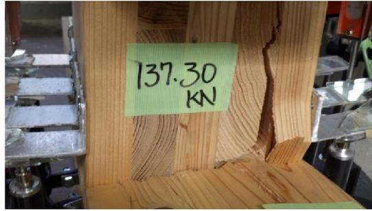
写真 4-10-1 試験終了時の土台へのめり込み状況
