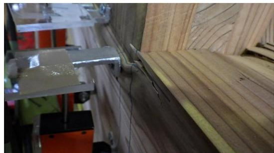
写真 4-53 試験終了時の土台の割れ 写真 4-54 試験終了時の土台へのめり込み
