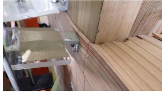
写真 4-18-2 試験終了時の土台へのめり込み
