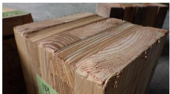
写真 4-11-3 CLT 下部の破壊状況
