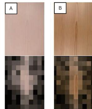
塗装の異なるスギ材 (上) と透かしモザイク図 (下)
