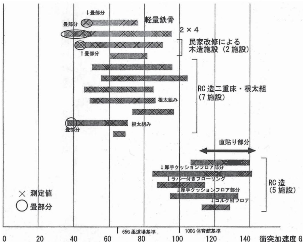
「床の硬さ試験 (JIS A 6519)」に基づく高齢者施設の床の硬さに関する実態調査
