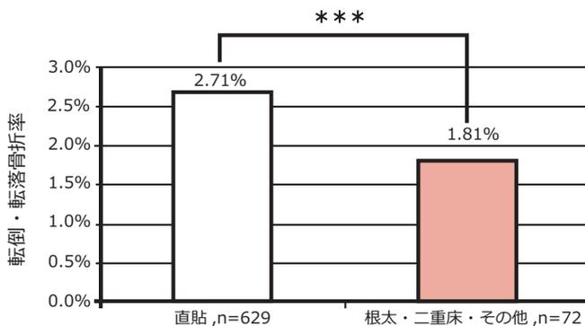
施設の主な床下地と転倒・転落骨折率 \*\*\*  $p < 0.01$
