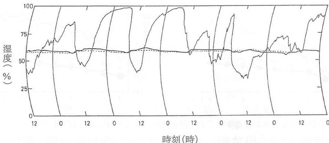
内装の違いによる室内の湿度変化／太線：木材、点線：ケイ酸カルシウム板、細線：百葉箱
