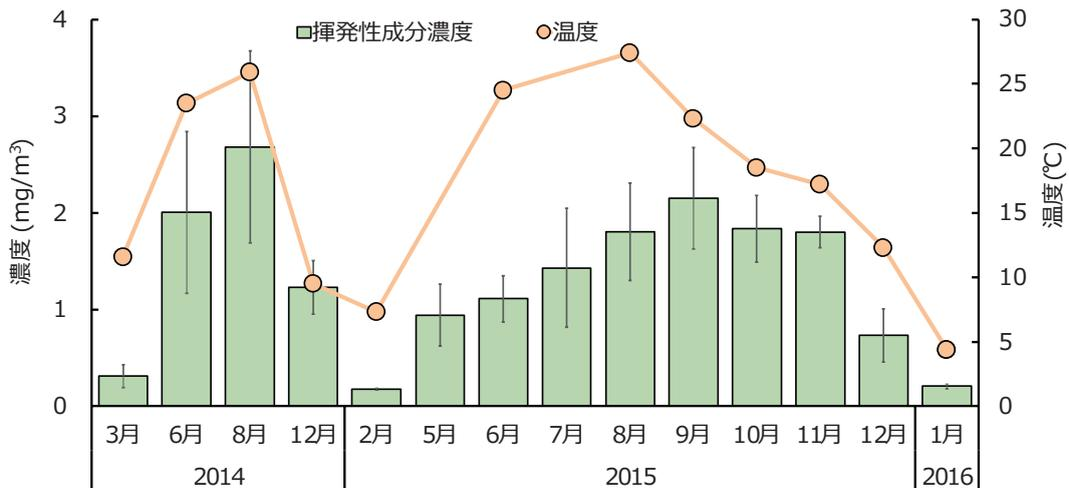
スギ材を内装に用いた室内の揮発性成分量の変化
