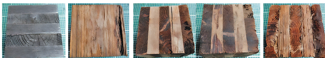
写真-3 地盤環境・温帯（三次）試験体の劣化状況の例
