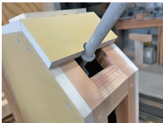
写真8 接合部試験体 製作（金物被覆あり、なし）
