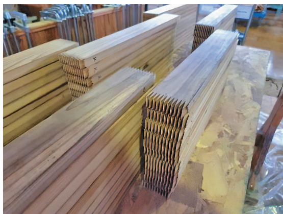
写真6 圧密ラミナのフィンガージョイントによるたて継ぎ作業
