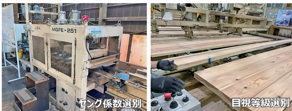
写真1 製材工場でのスギ206材の選別作業
