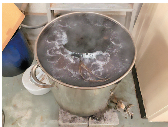
図3 接着剥離試験（煮沸処理）の様子
