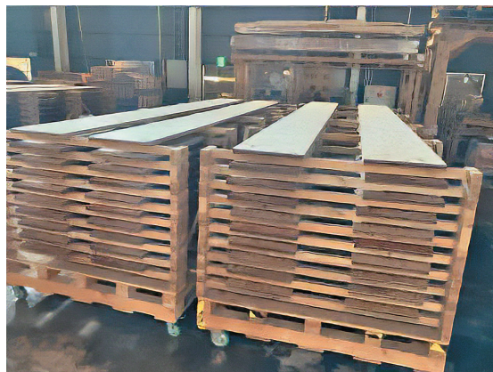
写真2 難燃薬剤処理スギLVL
