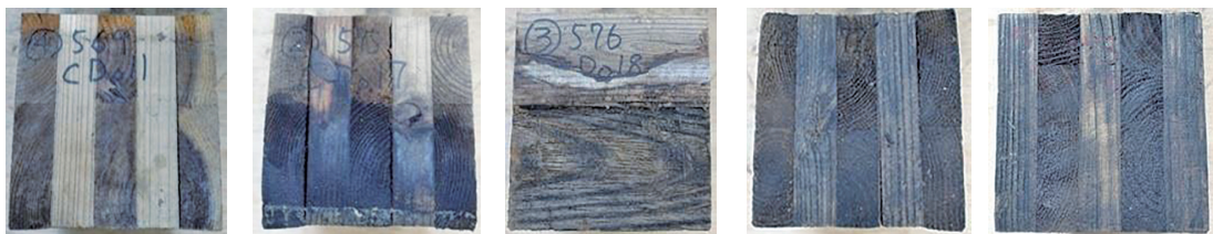
WL+0.1m 接着層近傍の亀裂 WL±0m 接着層近傍の亀裂、早材のやせ、黒・白色変色 WL-0.075m 幅はぎ隙間、表面荒れ、黒・白色変色 WL-0.15m 接着層近傍の亀裂、早材のやせ、黒・白色変色 WL-0.5m 早材のやせ、黒色変色
