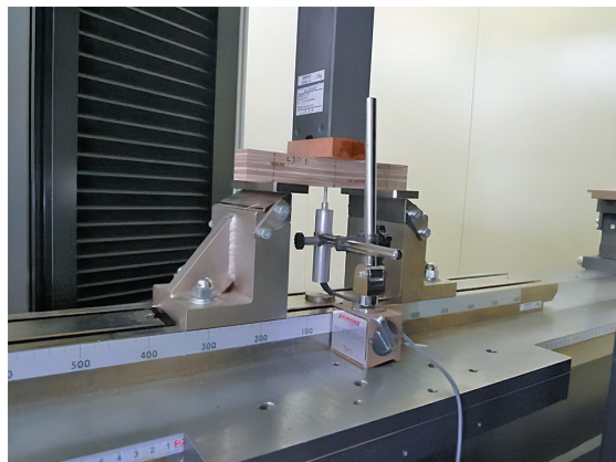
図7 水平せん断試験の様子（支点間距離は厚さの5倍）
