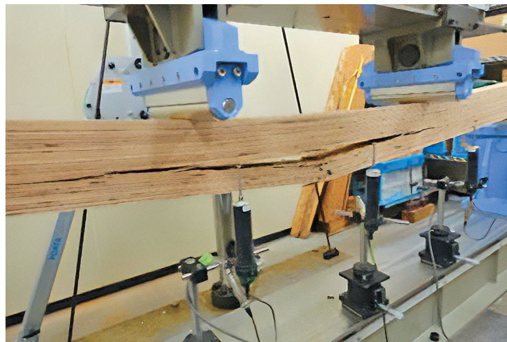
図10 曲げ試験時の破壊形態
