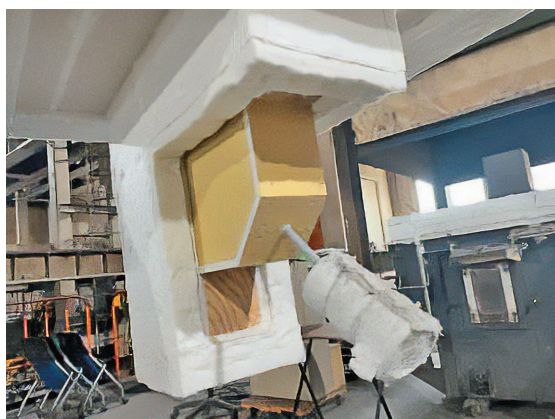
写真9 接合部試験前（左：金物被覆あり、右：金物被覆なし）
