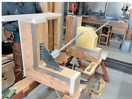
写真8 接合部試験体 製作（金物被覆あり、なし）
