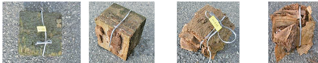
干満帯上段 上面ラミナに海藻類が付着 干満帯上段 下面ラミナ: 食害により消失。側面: フナクイムシの食害、表面: 緑色の藻のような付着物(めめり) 干満帯下段 フナクイムシ、キクイムシ(甲殻類)の食害で原形を留めていない 干満帯下段 接着層を残してフナクイムシ、キクイムシ(甲殻類)による食害
