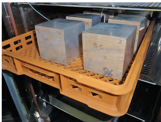
図5 寸法変化測定のための調湿の様子
