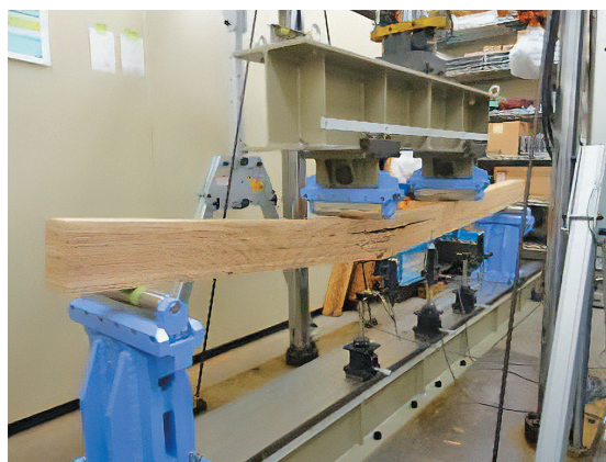
図2 曲げ試験の様子
