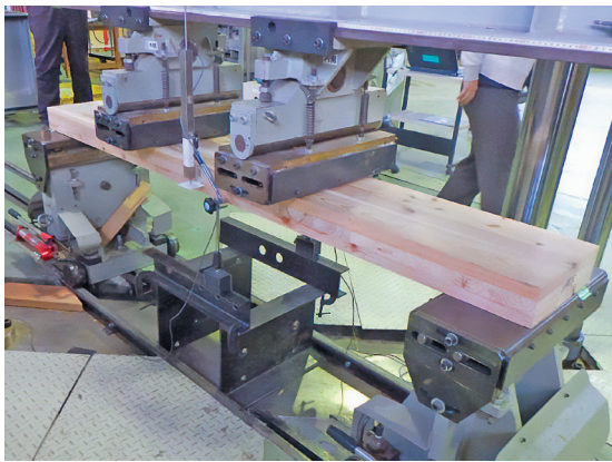
写真-7 曲げ試験の様子
