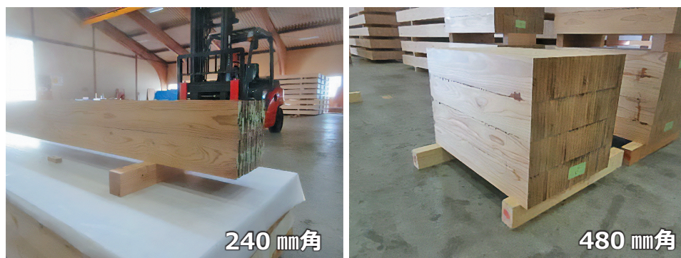
写真4 評価試験のために製作した圧密集成材
