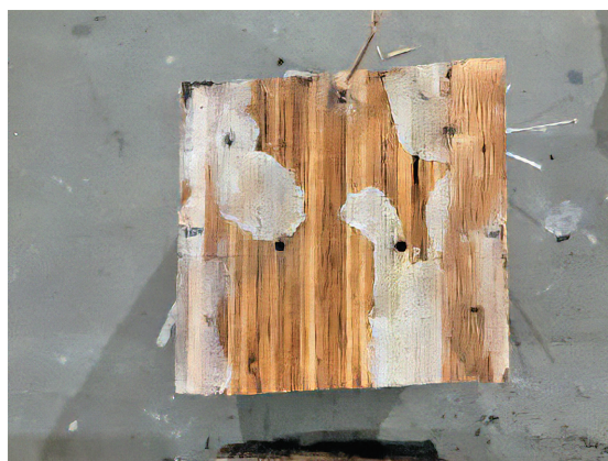
写真21 被覆材と荷重支持部の界面
