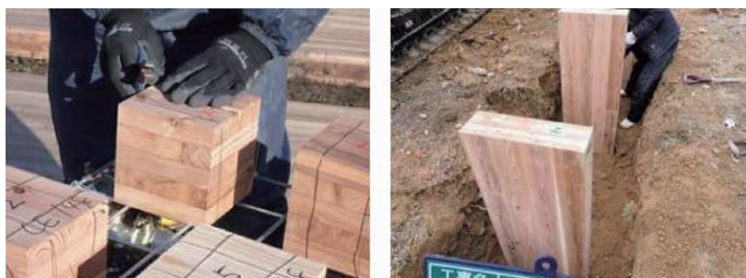
写真-1 CLT供試体（左：キュービック型試験体、右：ボード型試験体）
