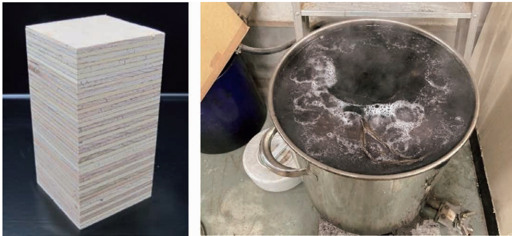
図3 接着剥離試験片、煮沸処理の様子（左：接着剥離試験片、右：煮沸処理）
