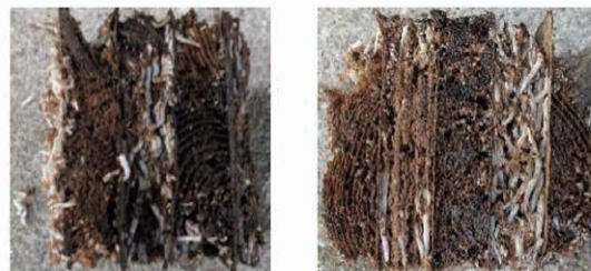
写真-15 劣化状況の例（海水中・横須賀）
