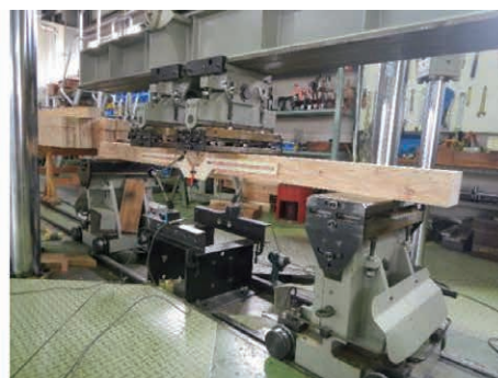
写真1-6 実大曲げ試験 (左：10層平使い、右：4層縦使い)
