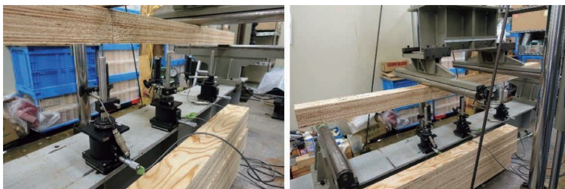
図1 曲げ試験の様子(左:変位計設置状況、右:加力状況)
