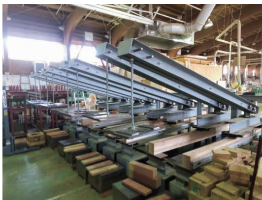
写真 1-8 曲げクリープ試験の载荷状況
