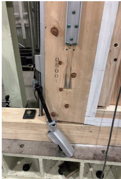
左 本試験 1 体目 ホールダウン金物の破断
