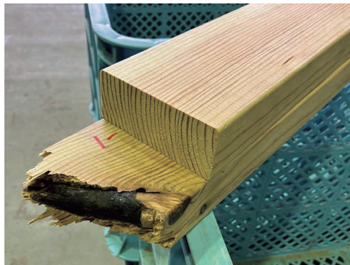
写真 4 柁目板の引張り破壊に関与した狭い面を貫通する節
