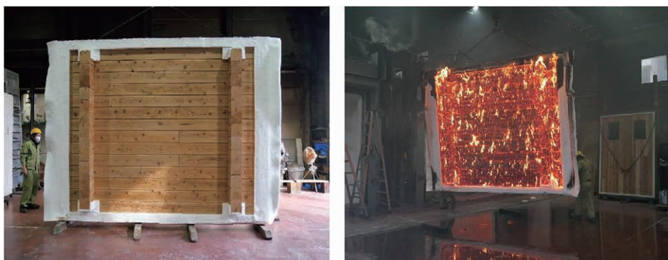
写真 1-2 本試験の様子 1 体目（左：試験前、右：試験後 ともに加熱側）
