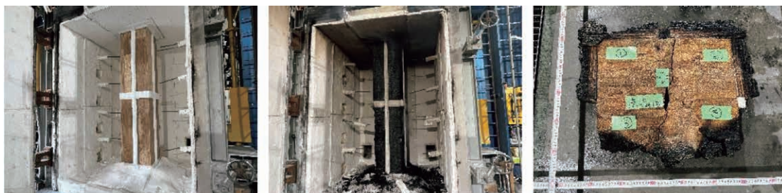
写真3 耐火試験前後
