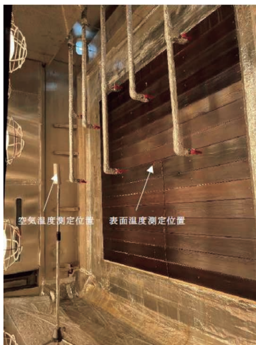
写真1 促進劣化試験（JIS A 1326: 2019 ）
