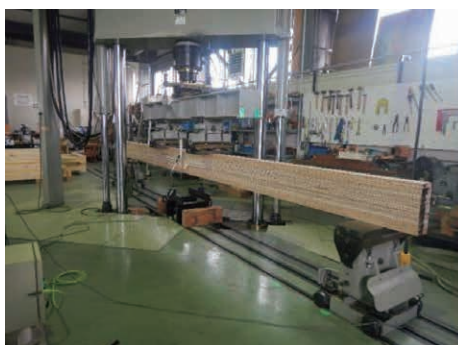
写真1-6 実大曲げ試験 (左：10層平使い、右：4層縦使い)
