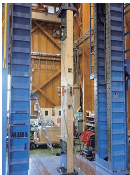
▲高耐力継手の引張実験：試験体組立および加力状況
