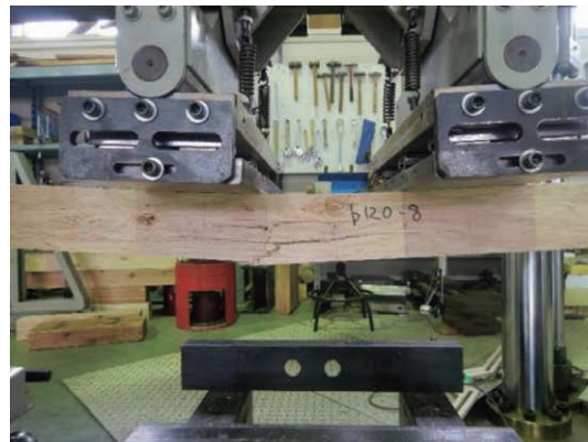
写真1-11 実大曲げ試験 (外層シラカンバ4層縦使い)
