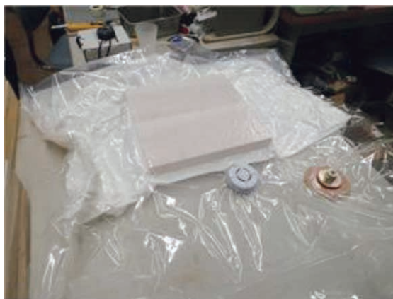
写真-2 真空プレスによる圧縮の様子
