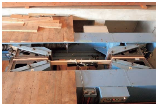
写真3 縦引張強度試験
