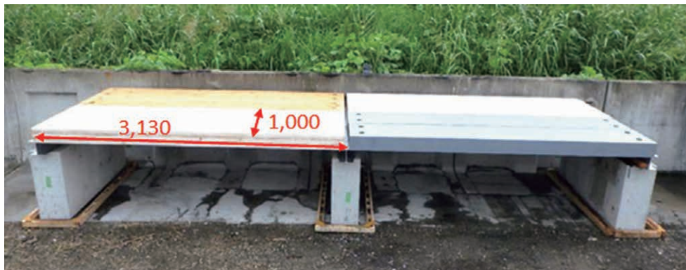
写真-9 モデルプラットフォームの屋外暴露状況
