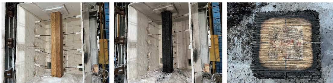
写真6 耐火試験前後
