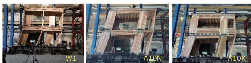
図3 水平加力倒壊実験(令和4年度)の倒壊限界状態
