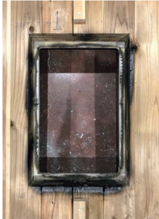
写真-13 解体時の開口小口の例 (試験体①仕様 1/CLT炭化あり)
