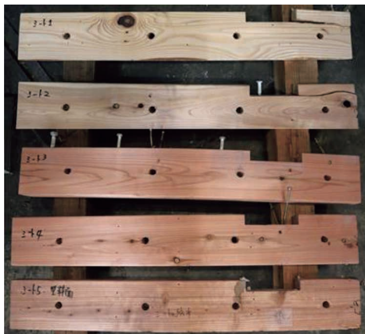
写真 8 解体ラミナの状況 (透湿防水シート仕様)
