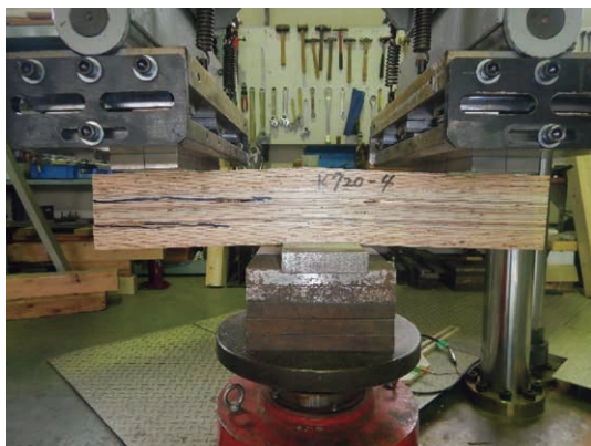
写真1-12 実大せん断試験 (外層カラマツ4層平使い)
