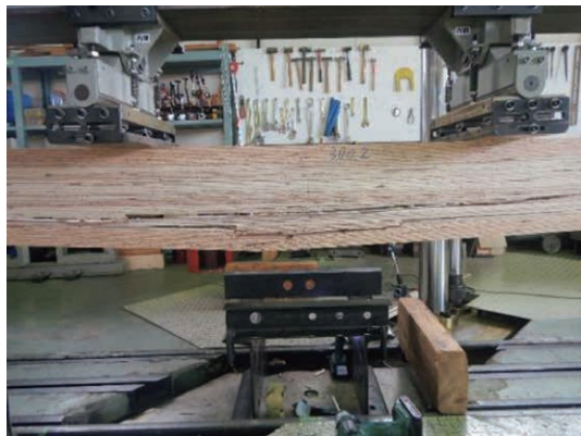
写真1-10 実大曲げ試験 (外層カラマツ10層平使い)
