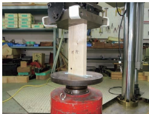
写真4 縦圧縮強度試験
