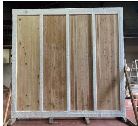
写真-4 試験体④の加熱面全景
