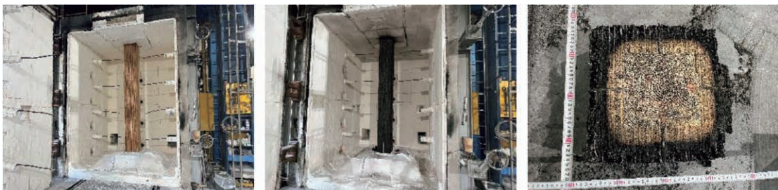
写真5 耐火試験前後
