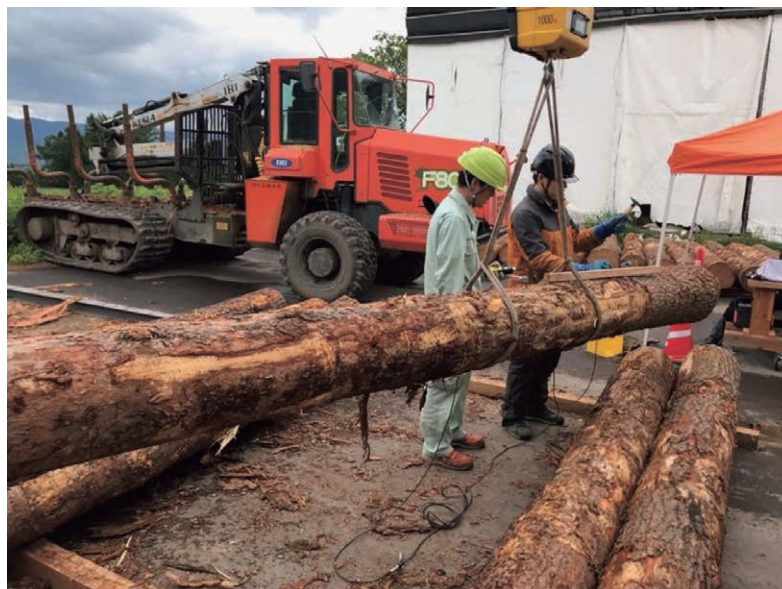
写真1 材質調査でアカマツ丸太の音速を測定している様子
