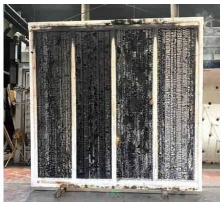
写真-20 試験体④の加熱面全景
