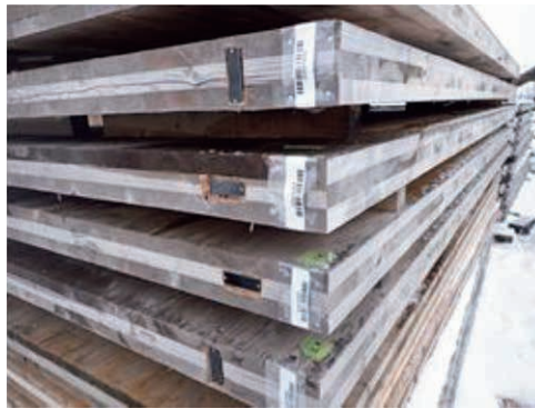
写真-24 CLT敷板へ取付けたRFIDタグ
