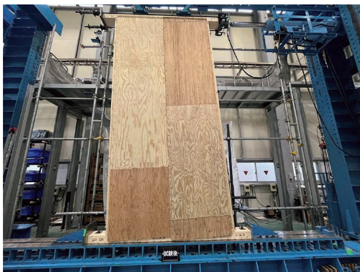
写真 2-4 実大水平構面試験
