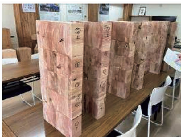
図8：接着性能試験後の試験片（木破）
