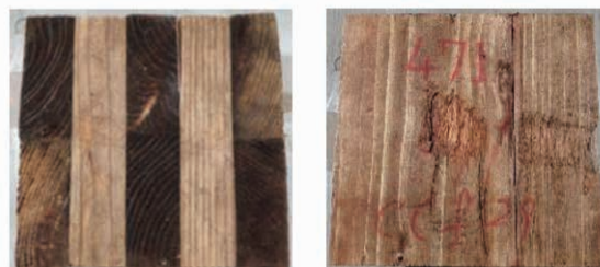
写真-14 劣化状況の例（土壌中・都城）
