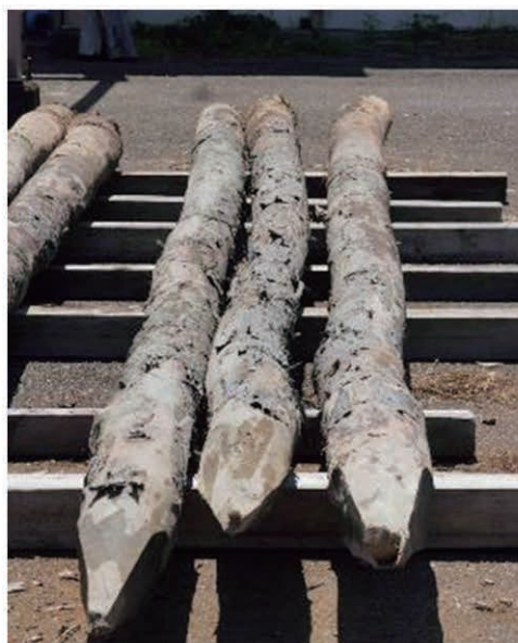
写真5 小浜市の橋脚基礎丸太
