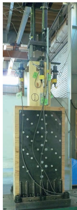
中高層用高耐力柱脚接合部 試験実施状況
