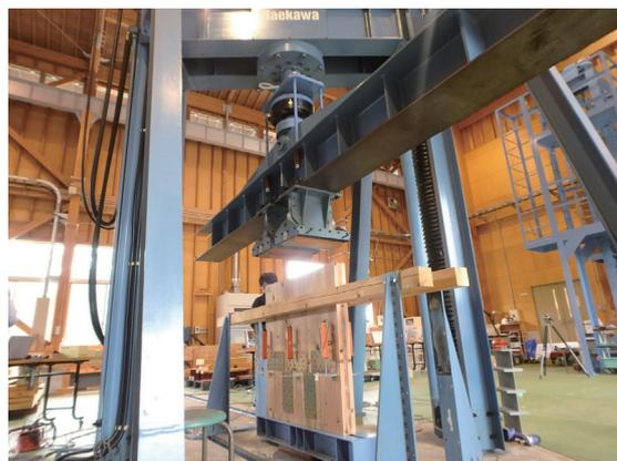
※3 補修・交換方法の実験の様子
