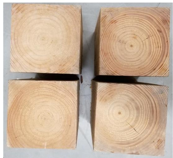
図8 高温セット処理24時間 + 中温乾燥後の内部割れ発生状況 (135 × 135 × 0.4m)
