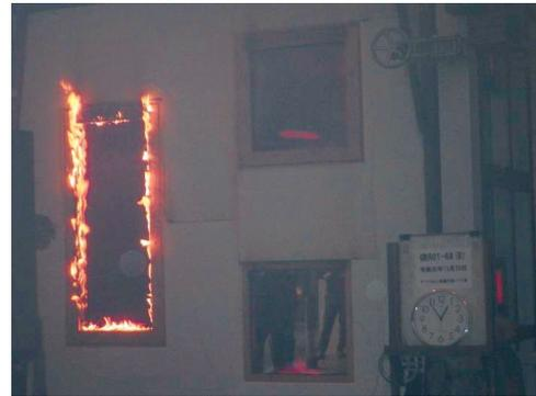
写真-5 FIX窓4窓 (ガラス変更)
