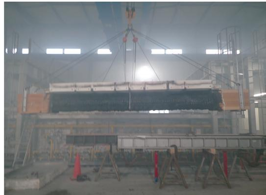
写真8 実大試験体：はり 90分加熱後
