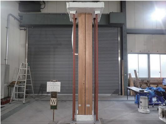
写真5 実大試験体：柱 加熱前
