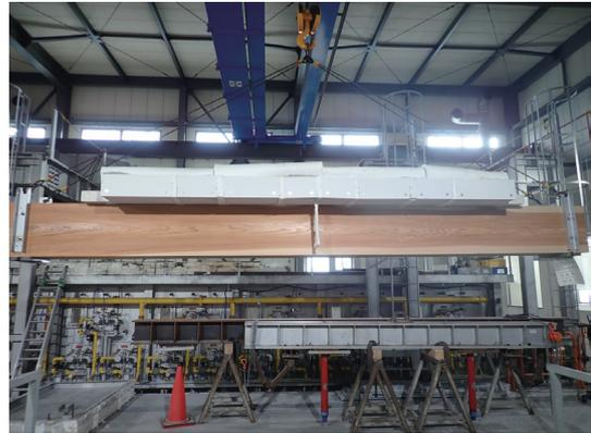
写真6 実大試験体：はり 加熱前
