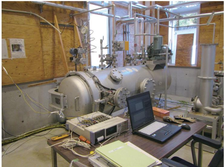
図4 蒸煮減圧に用いた圧力容器装置
