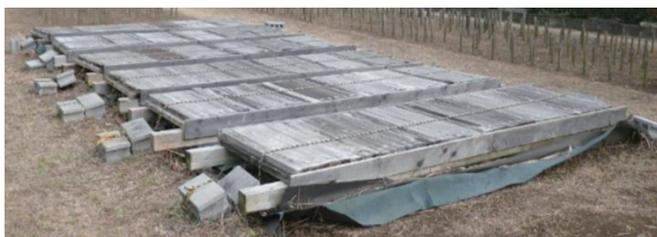
Wレイヤー試験（水平暴露試験）
