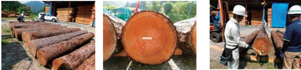
写真3 丸太供試体と測定状況
