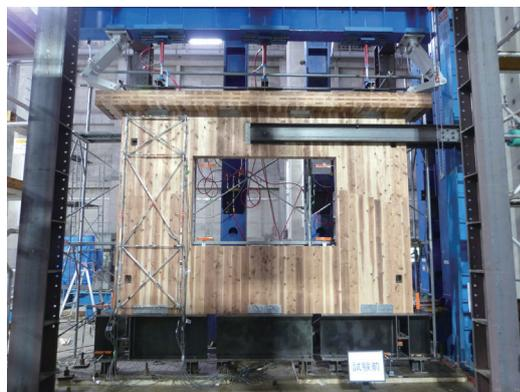
図2 大版パネル架構②構面水平加力実験
