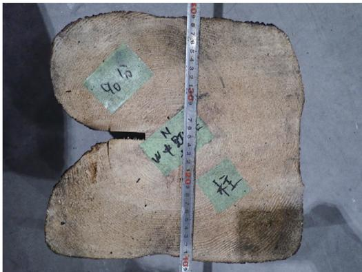
写真 11 小規模柱 90分加熱後 断面
