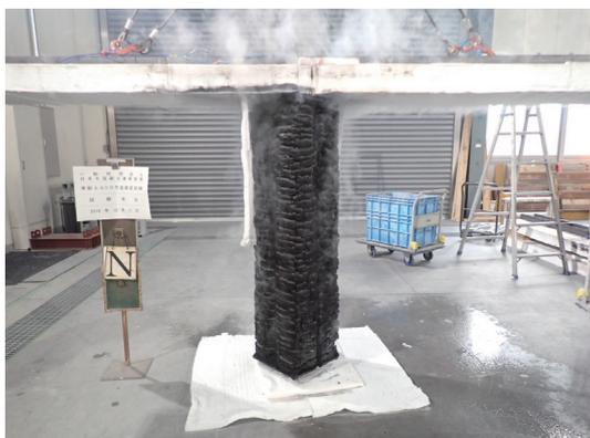
写真3 小規模試験体：柱 90分加熱後
