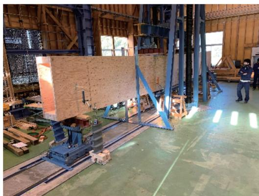
写真7 実大曲げ試験
