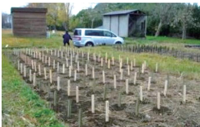
杭試験（野外防腐性能試験）
