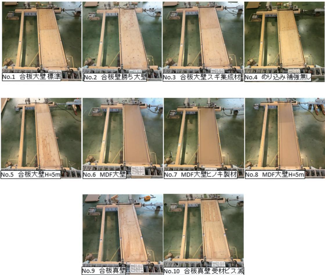
図-5 耐力壁パイロット試験 破壊性状写真
