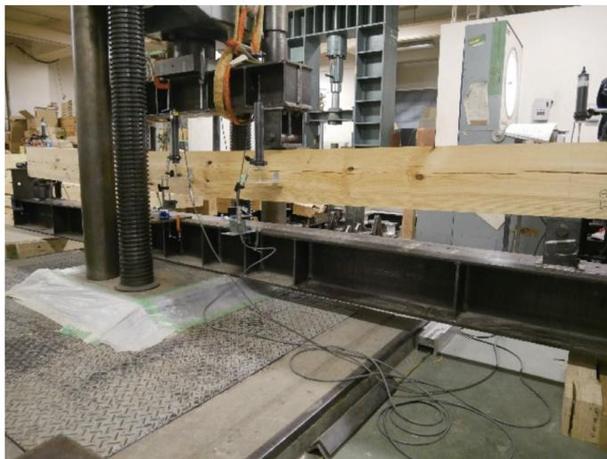
図5 強度試験機と変位計の設置状況
