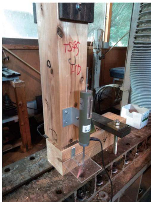
写真3 ホールダウン金物による接合部試験
