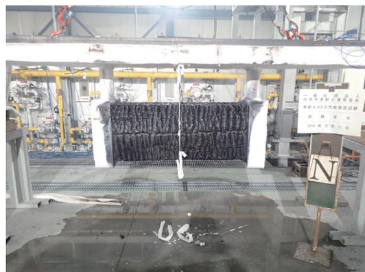
写真4 小規模試験体：はり 90分加熱後
