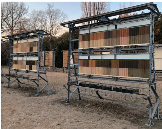
保存処理塗装木材の垂直暴露試験
