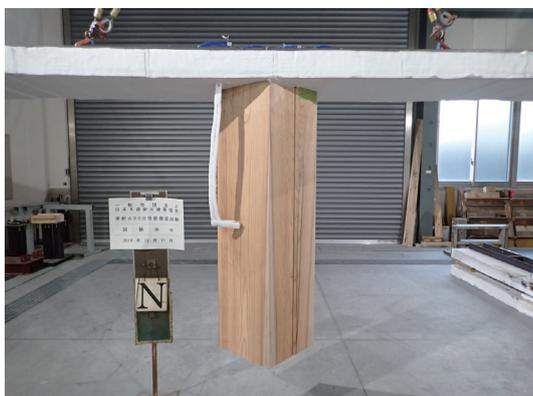
写真1 小規模試験体：柱 加熱前
