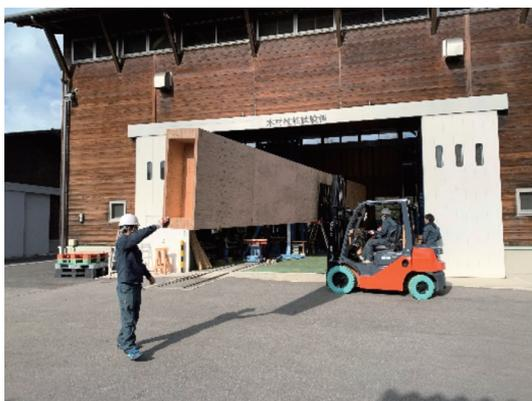
写真4 曲げ試験体
