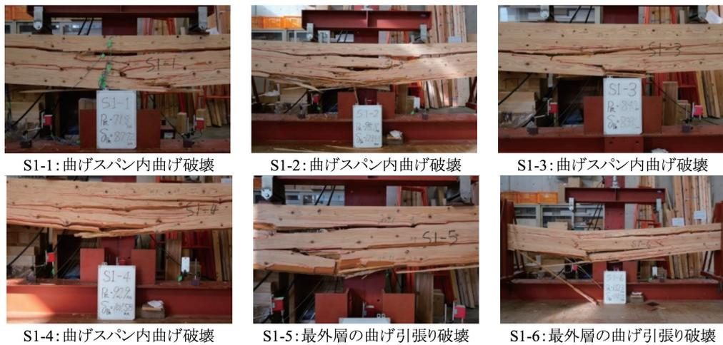
図 8. スギ試験体の破壊例
