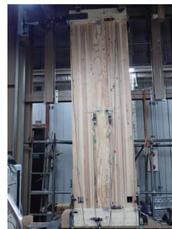
図3. 平角柱連結耐震壁 面内せん断試験：試験実施状況
