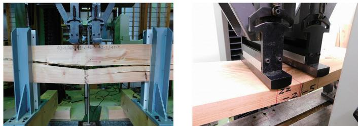
写真 4 FJのエッジ及びフラットワイズ曲げ強度試験の実施状況
