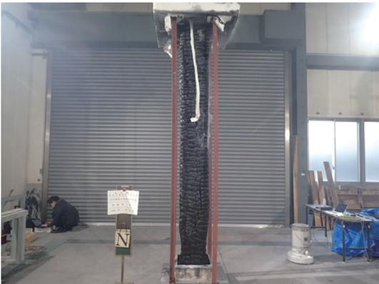
写真7 実大試験体：柱 90分加熱後
