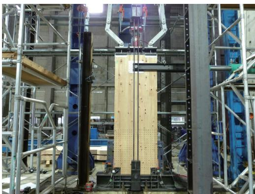
図4 壁パネル定軸力下水平加力実験
