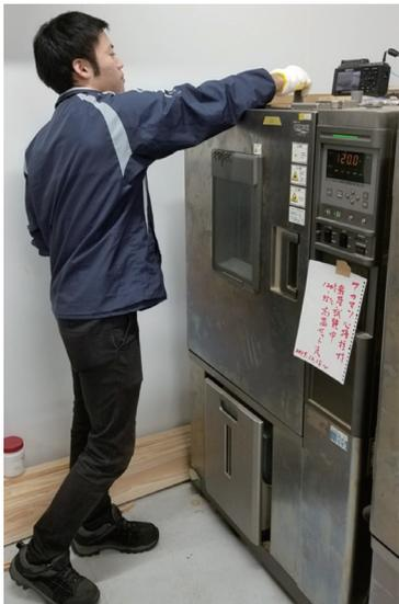
図3 木材乾燥試験に用いた恒温恒湿器
