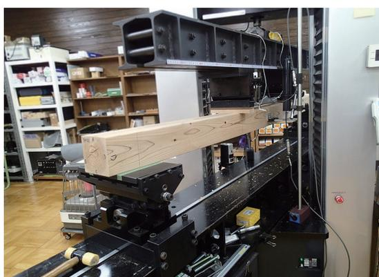
写真2 スギ正角の曲げ試験
